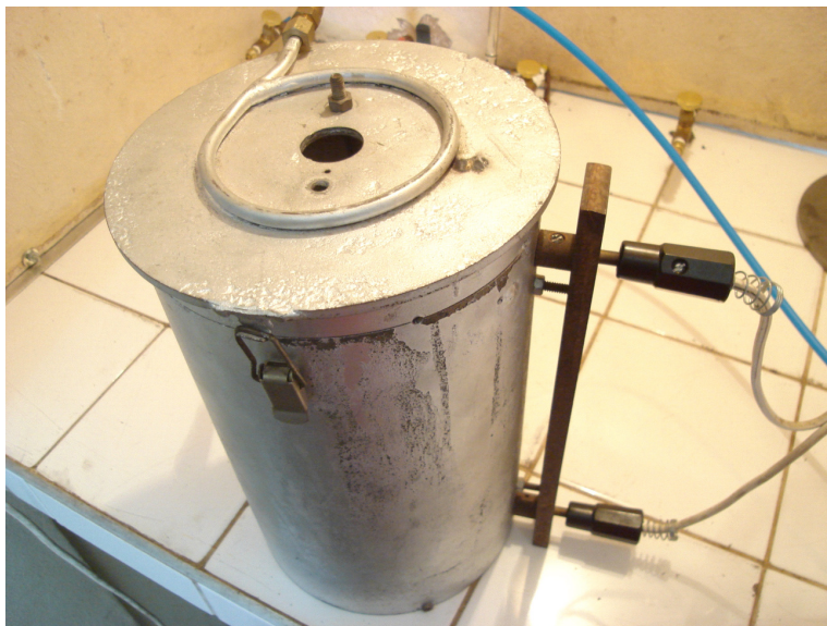
Figura 6: Forno para ensaio de ponto de fulgor e auto-ignição.
