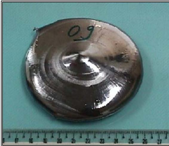
Figura 1.1 – Calota de silício após fusão no forno de feixe de elétrons [Pires, 2000].
