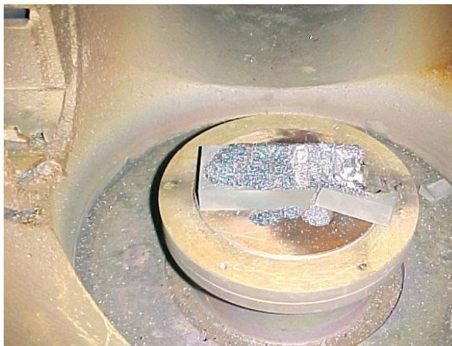
Figura 4.27 – Cadinho de SuperSiC-1 trincado dentro da câmara de fusão.
