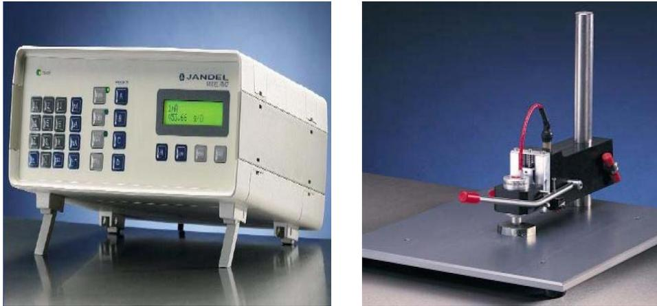
Figura 4.35 – Foto do aparelho da marca Jandel, modelo RM3, com porta amostra (à direita) utilizado para as medidas de resistividade do silício. Laboratório de Fusão por Feixe de Elétrons do DEMA-FEM-UNICAMP.
