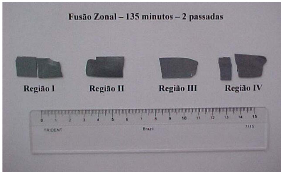
Figura 4.15 – Amostras utilizadas para medir resistividade. Lingote processado por 2 passadas com velocidade de 1 mm/minuto. Silício Liasa.
