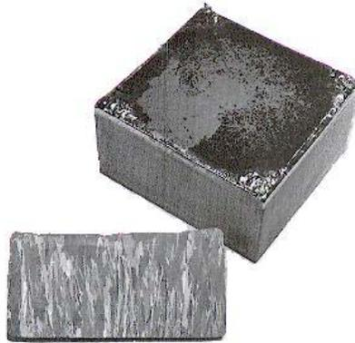
Figura 2.9 – Lingote produzido pelo sistema HEM [Crystal Sistem, 2009].
