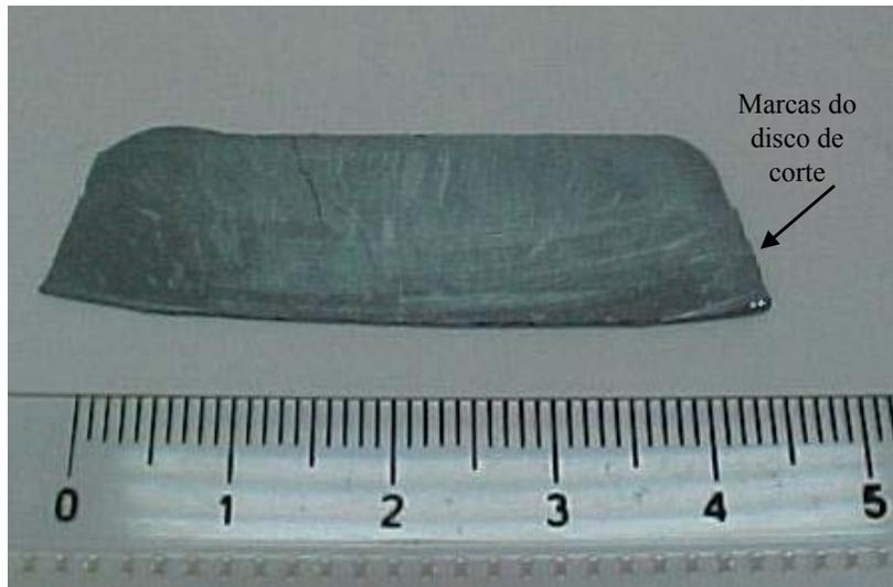
Figura 5.54 – Marcas em lâminas retiradas do lingote C1P2L (região 3), processado com 2 passadas de fusão zonal em cadinho de cobre.
