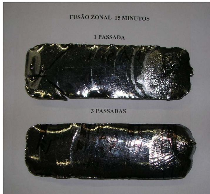
Figura 4.10 - Lingotes após 1 e 3 passadas de fusão zonal com velocidade de 10 mm/minuto. Silício Liasa.
