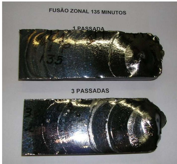
Figura 4.11 - Lingotes após 1 e 3 passadas de fusão zonal com velocidade de 1 mm/minuto. Silício Liasa.
