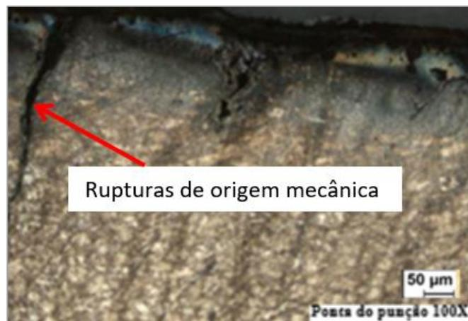
Figura 4.59 - Análises metalográficas - Ponta do punção
