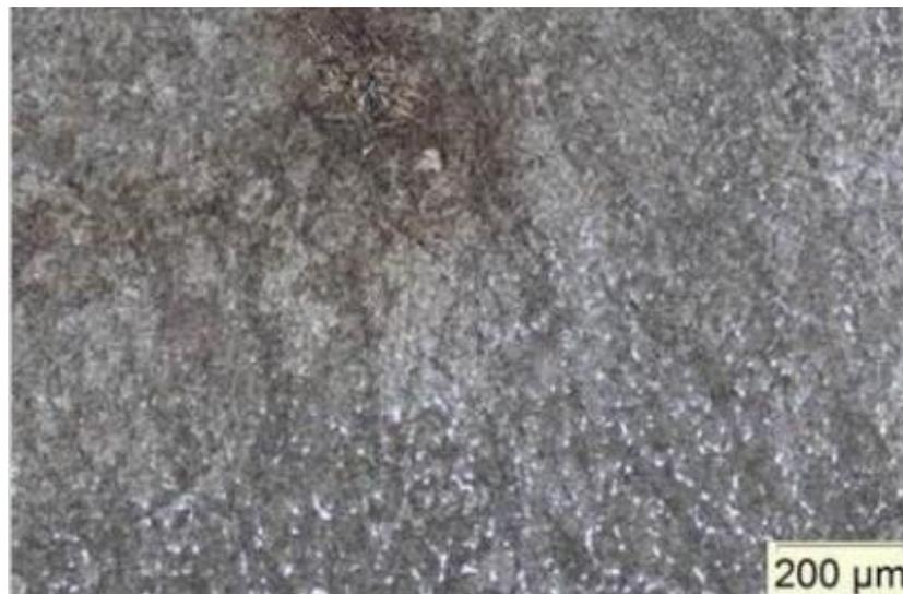
Figura 4.26 - Região 2: Camada soldada microestrutura martensítica fina e revenida.
