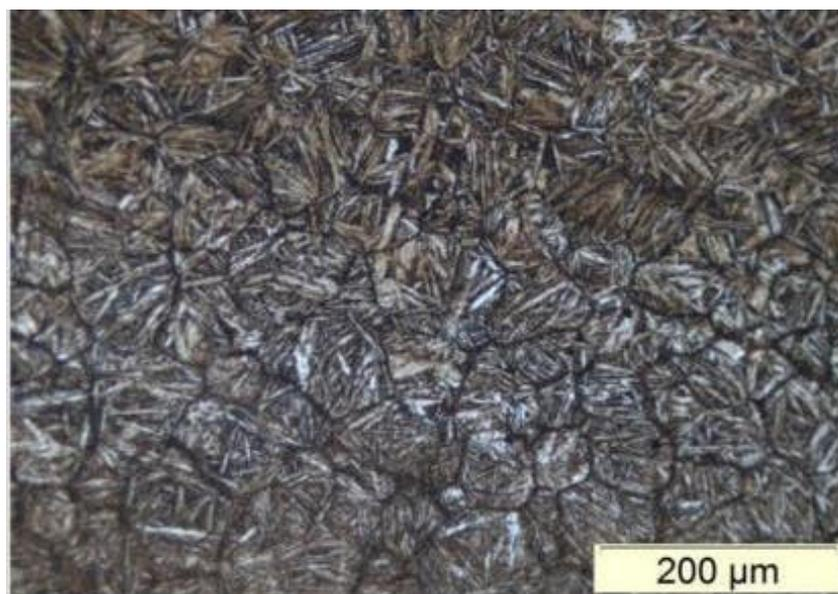
Figura 4.21 - Região 3: Região de fusão do material base com a solda caracterizada pelo tamanho de grão austenítico.
