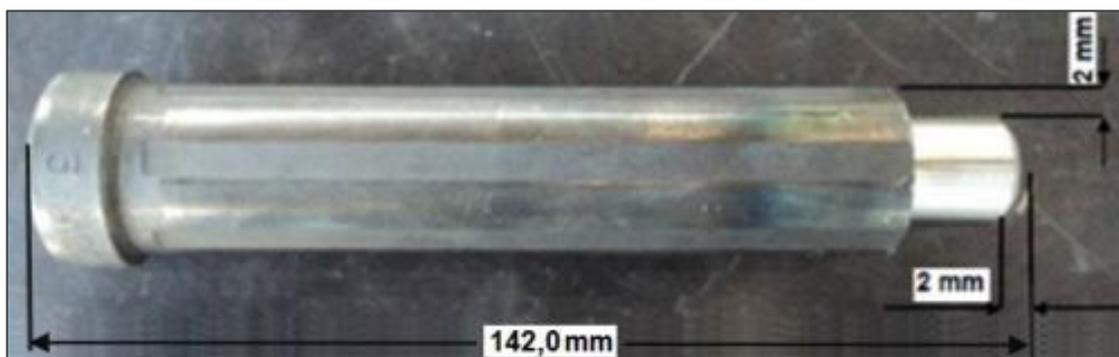
Figura 3.3 - Punção com rebaixamento para preenchimento de solda
