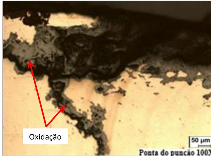
Figura 4.38 - Análises metalográficas - Ponta do punção
