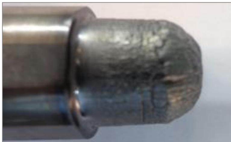
Figura 3.2 - Punção desgastado,
