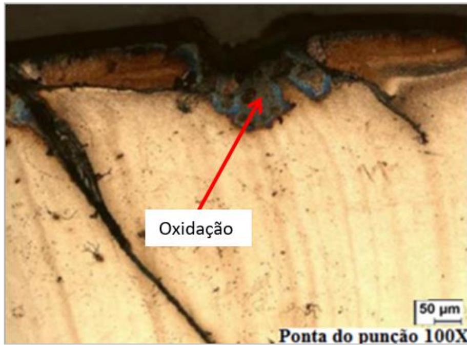
Figura 4.33 - Análises metalográficas - Ponta do punção
