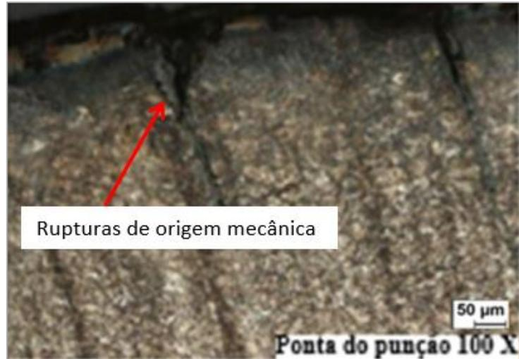
Figura 4.54 - Análises metalográficas - Ponta do punção
