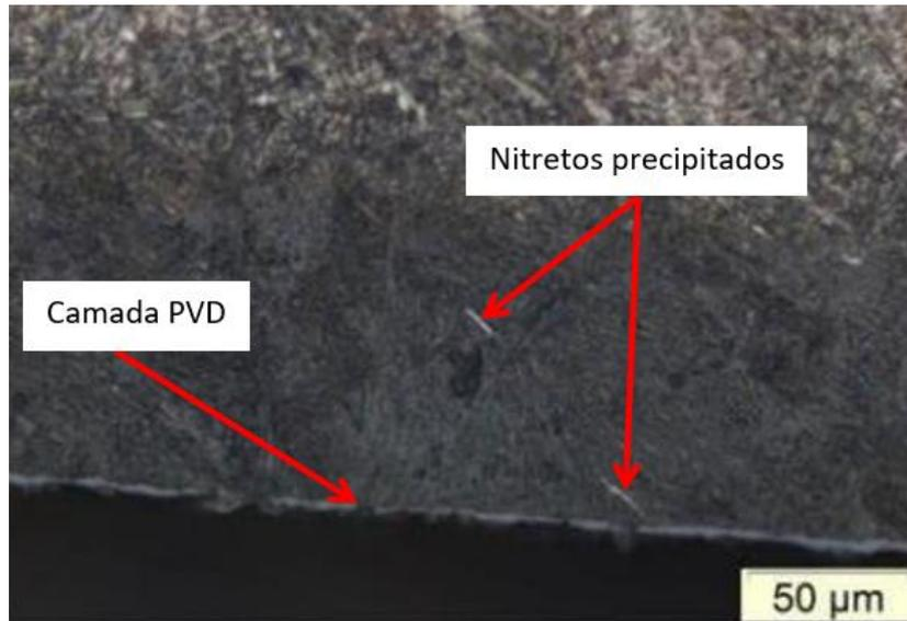
Figura 4.25 - Região 1: camada nitretada, nitretos precipitados no contorno de grão e camada de PVD.
