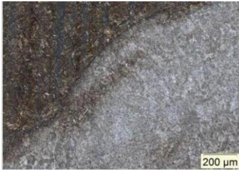
Figura 4.27 - Região 3: Região de fusão do material base com a solda caracterizada pelo tamanho de grão austenítico.
