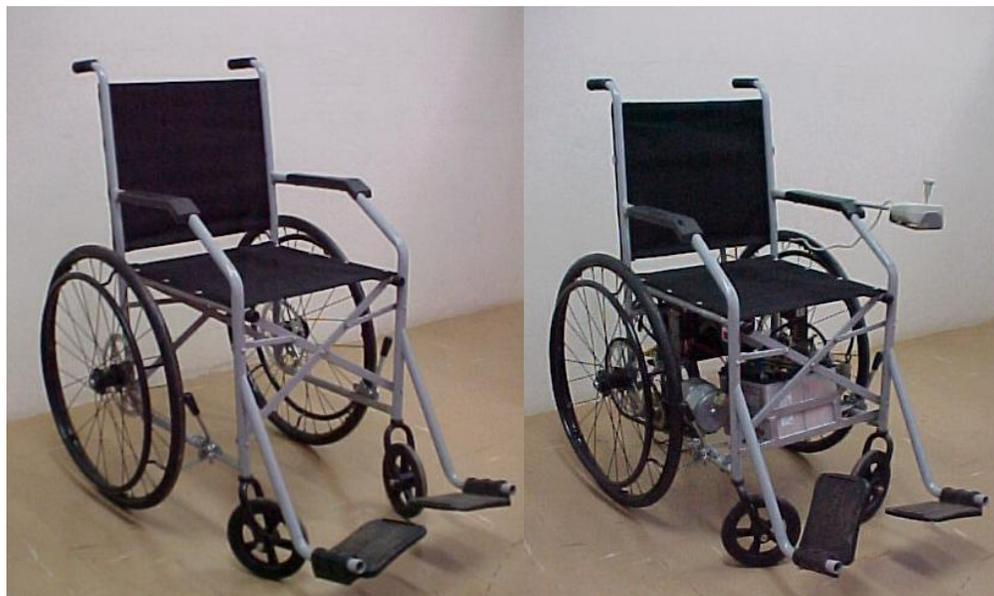
Figura 72 – Segundo protótipo funcional da cadeira de rodas automatizada. É mostrada a cadeira sem automatização (esquerda) e com automatização (direita).
