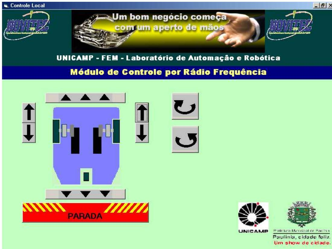
Figura 8- Exemplo de interface com o usuário utilizada para controlar remotamente os movimentos de um robô móvel.
