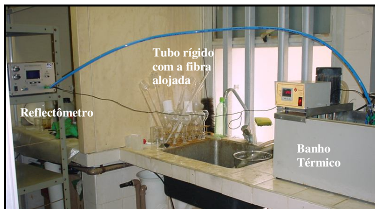
Figura 3.3. Montagem experimental para análise dos combustíveis.
