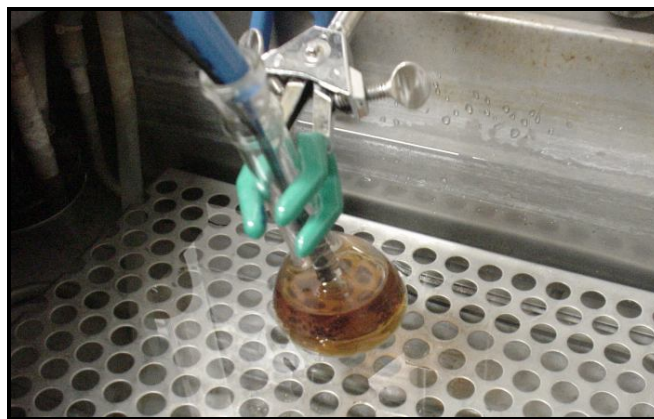
Figura 3.4. Combustível imerso no banho térmico.
