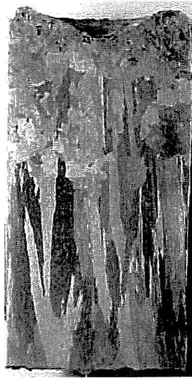
Figura 5.39- Macroestruturas obtidas com chapa molde de aço 1020 polida e recoberta: Al-10%Cu.
