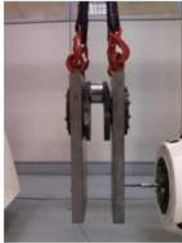
Figura 7.5: Aparato experimental para ensaio de fadiga de virabrequins sob carga de flexão (VILLALVA E FERRACINI, 2010).
