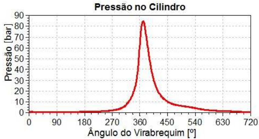
Figura 3.2: Curva de pressão no cilindro para um motor de ciclo Otto.
