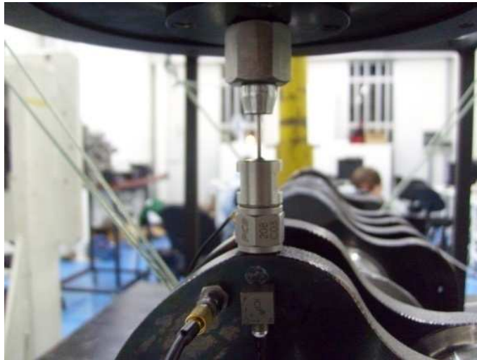
Figura 4.10: Acoplamento entre o excitador dinâmico e o virabrequim utilizando stinger e célula de carga (RODRIGUES et al. , 2011).
