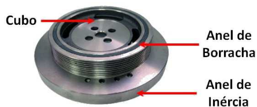
Figura 6.2: Absorvedor de vibrações torcionais sintonizado com anel de borracha (FLUIDAMPR, 2012).
