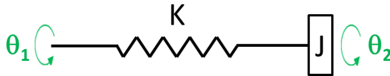
Figura 5.11: Representação esquemática de um oscilador simples.
