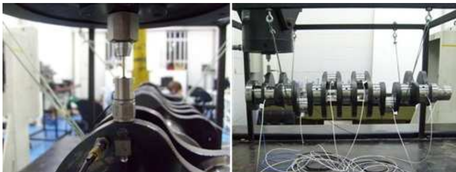
Figura 4.5: Aparato para análise modal experimental de um virabrequim de seis cilindros em linha (RODRIGUES et al. , 2011).
