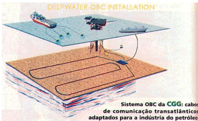
Figura 2-3: Sistema de aquisição de sísmica através de cabo de fundo (Cordeiro, 2002).
