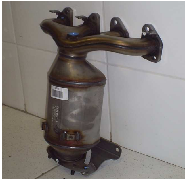
Figura 3.5: Conversor Catalítico posição “Close Couple”. Fonte: Umicore
