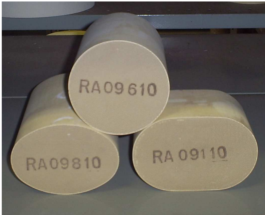
Figura 3.4: Geometrias de substratos cerâmicos – Fonte: Umicore
