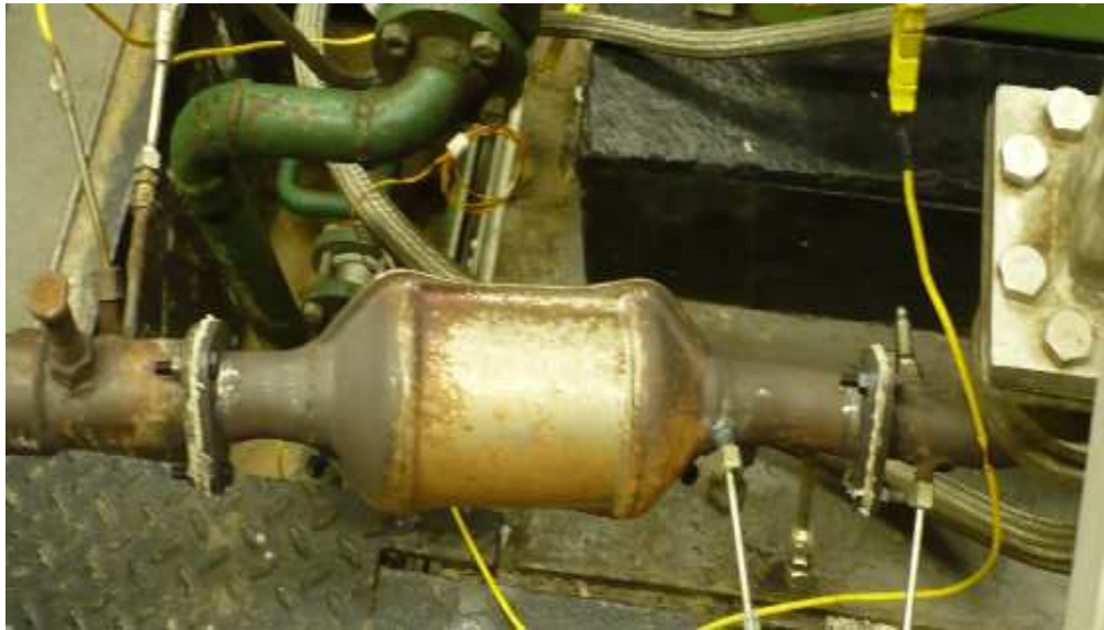
Figura 5.1: Conversor instalado em banco de provas de motores. Fonte: Umicore
