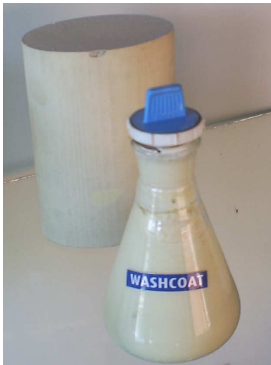
Figura 3.6: Frasco contendo “ wash-coat ”. Fonte: Umicore
