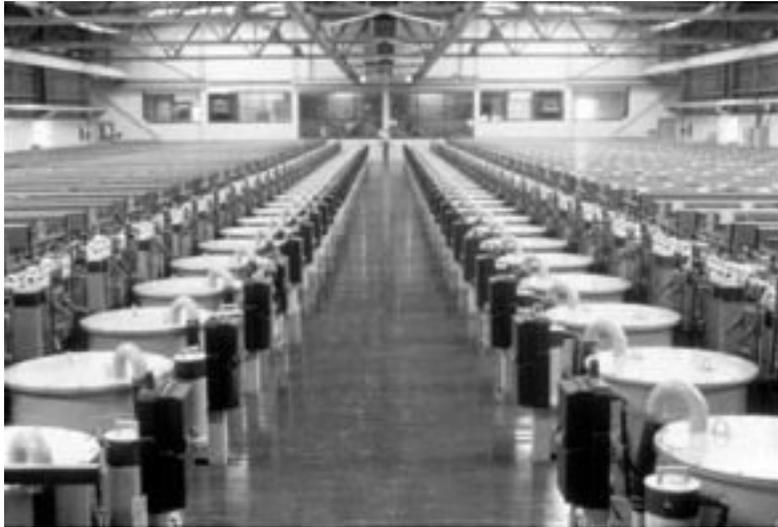
Figura 1.2. Vista do corredor central de uma casa de células mostrando os vasos cilíndricos onde ocorre a desamalgamação para produção de soda cáustica e hidrogênio [52].
