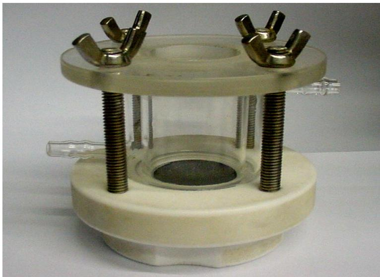
Figura 3.1: Foto da célula eletroquímica mostrando a jaqueta lateral para refrigeração e o eletrodo de trabalho posicionado na base.
