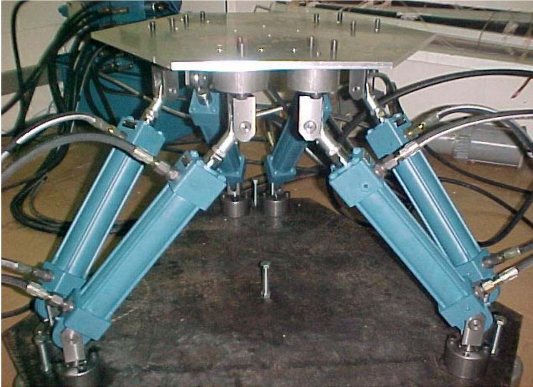
Figura 5.3 Plataforma de Posicionamento implementada no LAR-UNICAMP.
