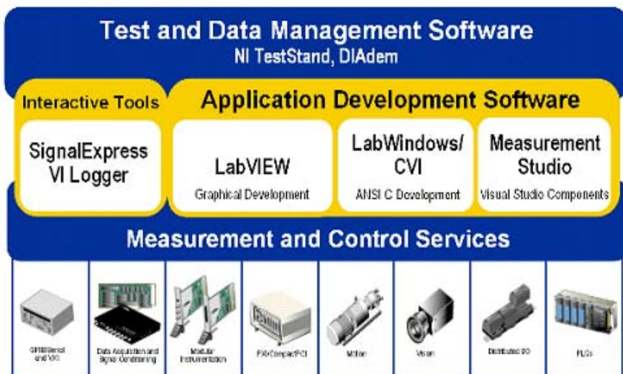
Figura 4.5: Camadas de Software para Instrumentação Virtual (NI Instruments).
