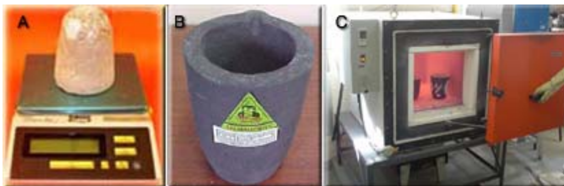
Figura 4.2 - Balança digital (A), cadinho de carboneto de silício (B) e forno elétrico tipo mufla (C).
