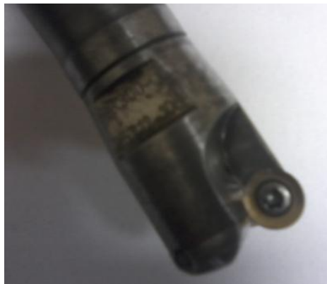
Figura 3.15 - Ferramenta de corte com dois insertos: imagem da ferramenta
