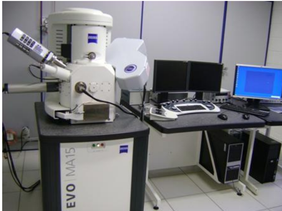
Figura 3.3 - Microscópio Eletrônico de Varredura (MEV)
