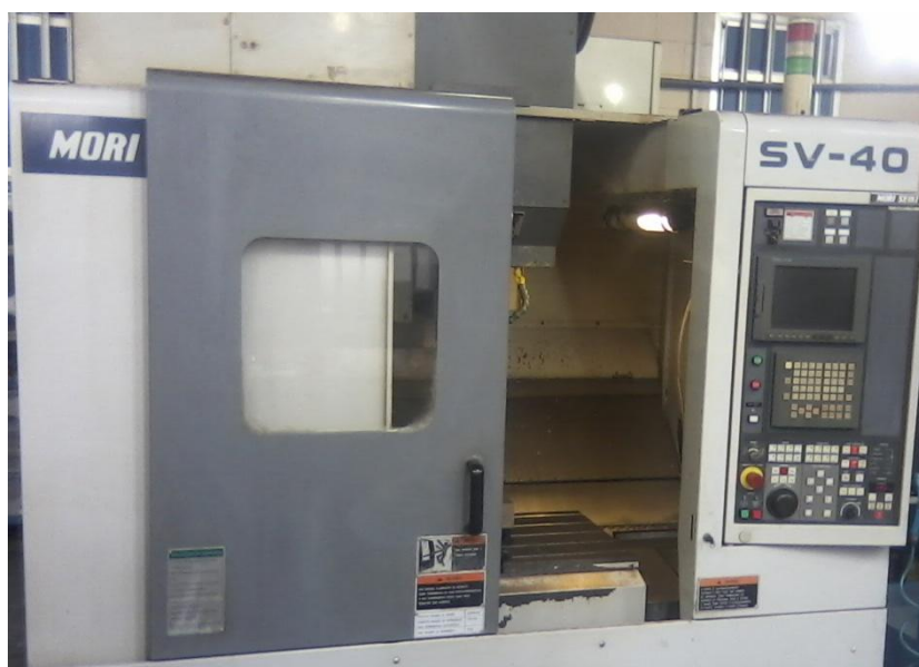
Figura 3.1 - Centro de usinagem 3 eixos, usado nos ensaios de fresamento
