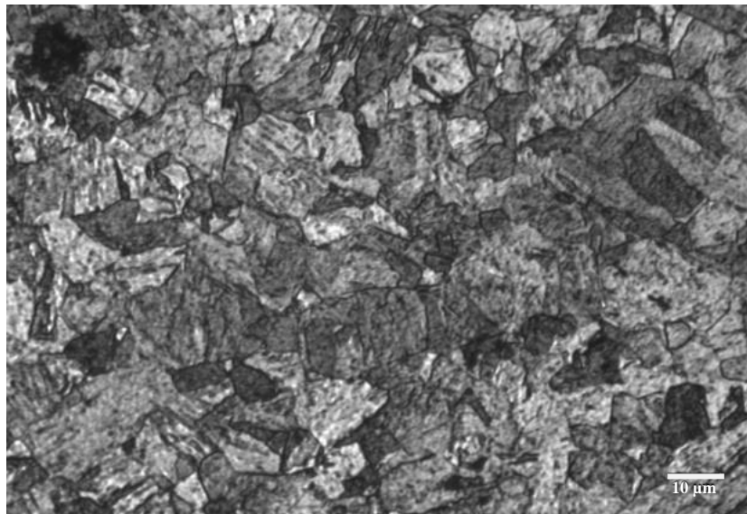
Figura 2.3 - Fotomicrografia do aço inoxidável 15-5 PH na forma precipitado: ampliação de 500x (SILVA, 2011)
