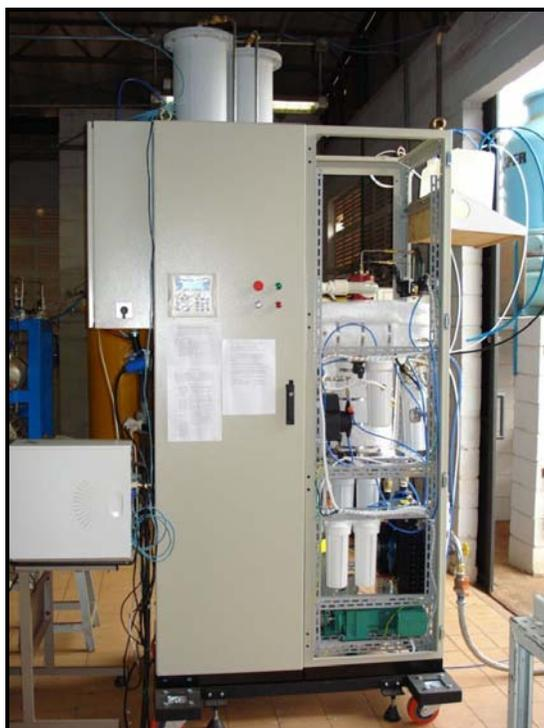
**Figura 1.2 – Protótipo do reformador de etanol, para célula a combustível do tipo PEMFC de 5.000 W.**
