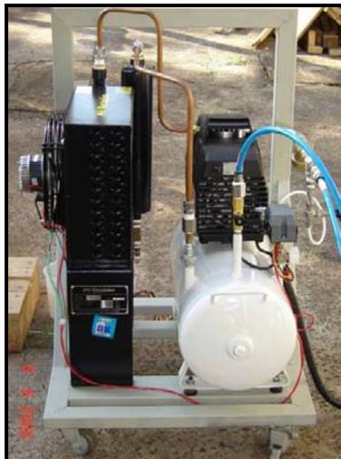
**Figura 4.4 – Resfriador-condensador do gás de síntese a alta pressão (esquerda) e compressor para o gás de síntese (direita). Fonte: Elaboração própria.**
