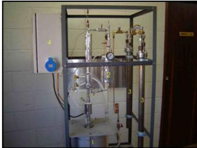
**Figura 1.1 – Protótipo do reformador de etanol, para célula a combustível do tipo PEMFC de 500 W . Fonte: CAMARGO, 2004.**
