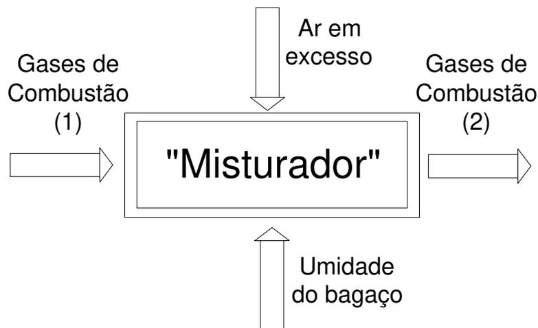
**Figura 4.7** Volume de controle no processo de mistura e evaporação da umidade do bagaço.
