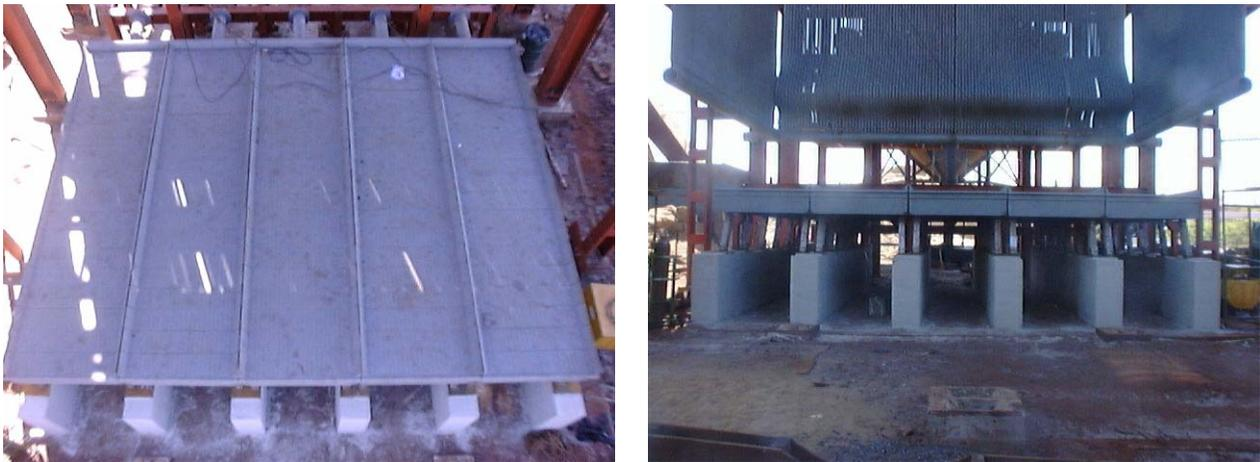
**Figura 2.15** Grelha vibro-fluidizada
