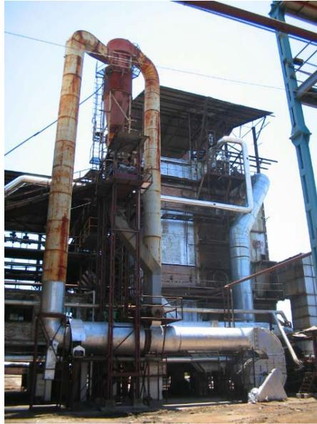
**Figura 2.14** Secador de bagaço de cana – Usina Leales (Saab, 2004).
