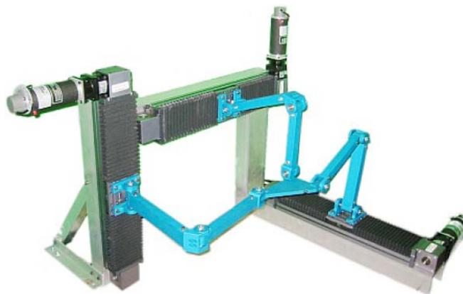
**Figura 6: Manipuladores com 3 Graus de Liberdade – orthoglide (Pashkevich et al., 2006).**
