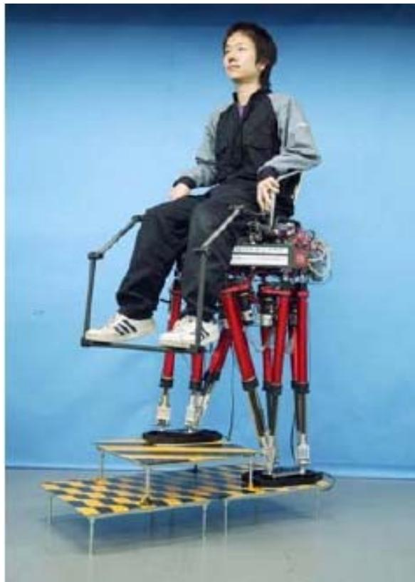
**Figura 31: Sistema de locomoção bípede WL-16RII (SUGAHARA et al. , 2005)**
