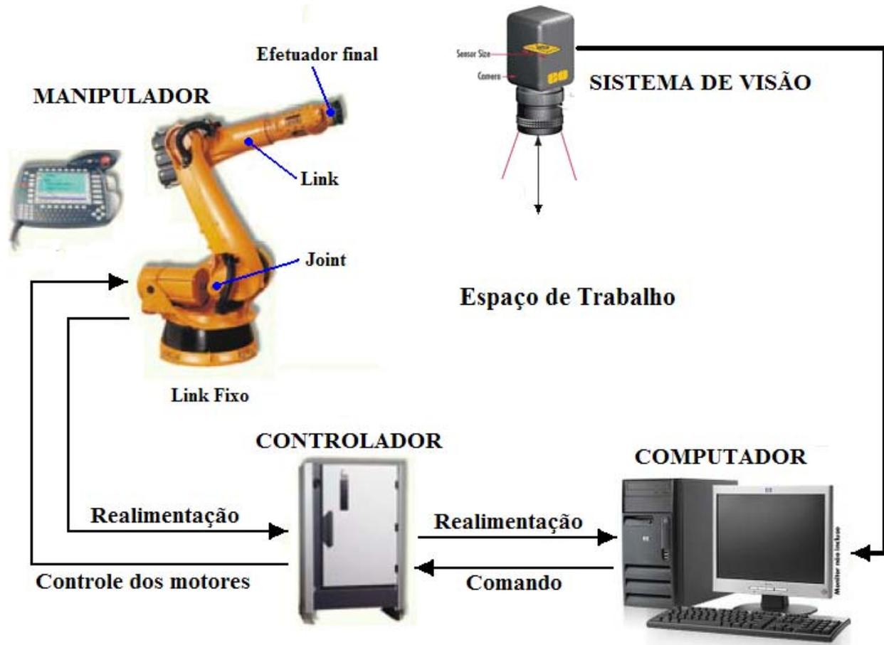
**Figura 2: Elementos de um sistema Robótico**
