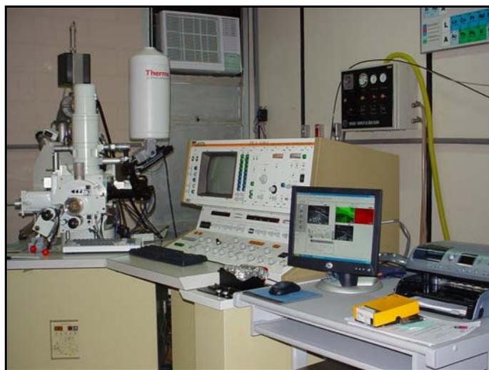
Figura 3.5 – Fotografia do microscópio eletrônico de varredura (MEV) utilizado nas análises fratográficas.
