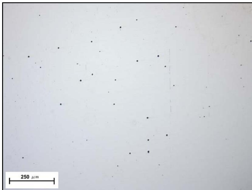
Figura 4.7 – Micrografia, sem ataque químico, do fio-máquina nacional mostrando as inclusões características encontradas neste material.
