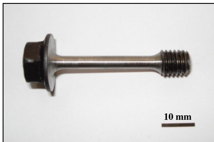
Figura 4.11 – Fotografia de um dos corpos-de-prova, usinados a partir de parafusos, utilizados nos ensaios de tração.
