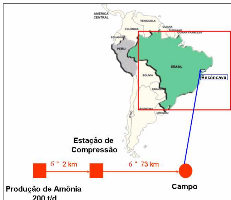
Figura 6.2: Esquema do seqüestro de CO 2 no campo maduro de óleo na Bacia do Recôncavo
