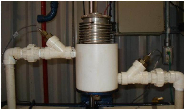
*Figura 3.6 - Vaso calorimétrico.*
