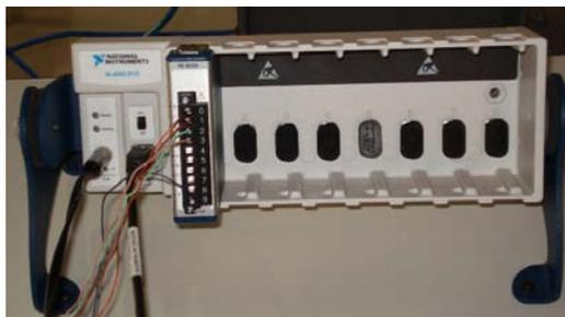
Figura 3.7 - Sistema de aquisição de sinais Compact DAQ.
