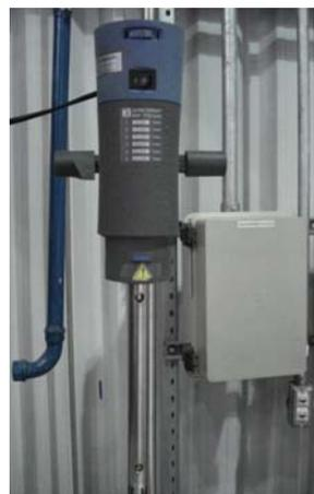
*Figura 3.3 - Aparelho homogeneizador rotativo TURRAX.*
