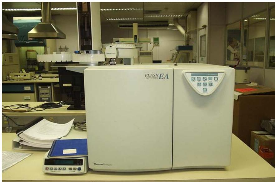
**Figura 3.7** - Analisador de C, H e N, FISION EA 1110
