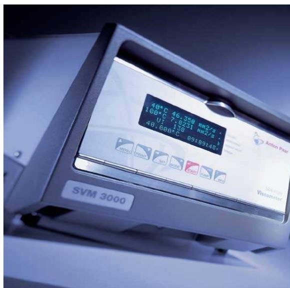
**Figura 3.17** - Viscosímetro e Densímetro, Stabinger SVM3000 da Anton Parr
