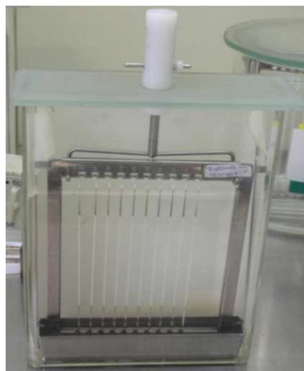
**Figura 3.13** – Suporte com os bastões inseridos em tanque de solvente
