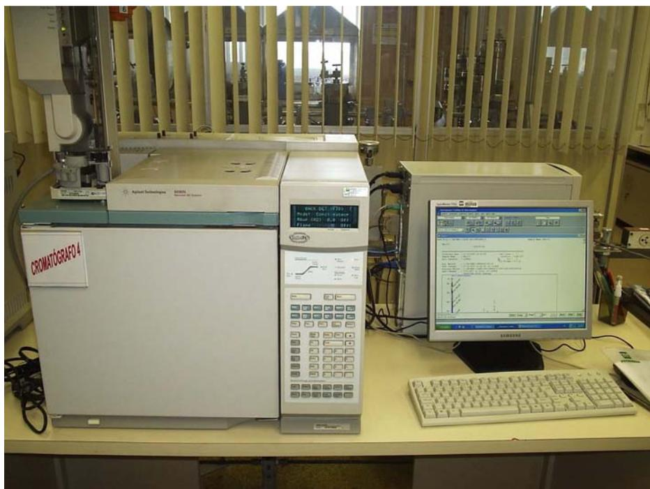
**Figura 3.16** - Cromatógrafo a Gás, modelo HP6890N, Agilent Technologies
