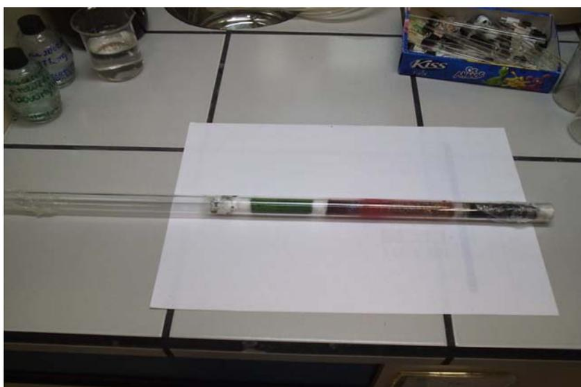
**Figura 3.6** – Tubo de quartzo com recheio químico para análise CHN
