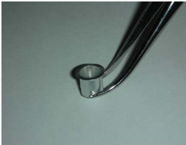
**Figura 3.19** – Suporte de alumina para análise DSC
