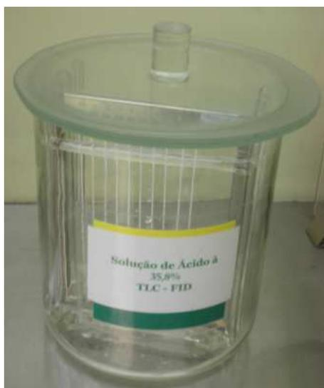
**Figura 3.12** – Tanque de umidade constante com os bastões de sílica
