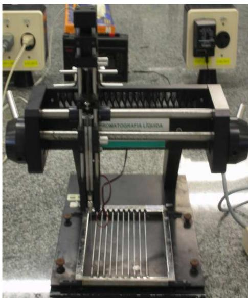
**Figura 3.10**– Injeção automática da amostra nos bastões
