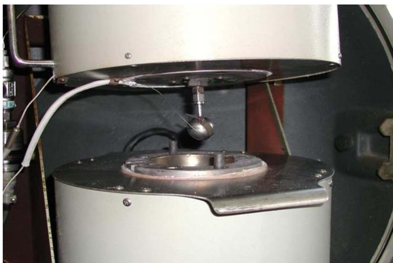
**Figura 2.1** – Bomba calorimétrica do equipamento ARC (CARDILLO, 2005)
