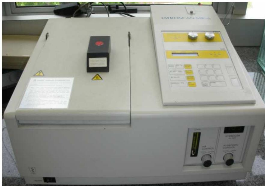
Figura 3.14 – Equipamento de TLC-FID
