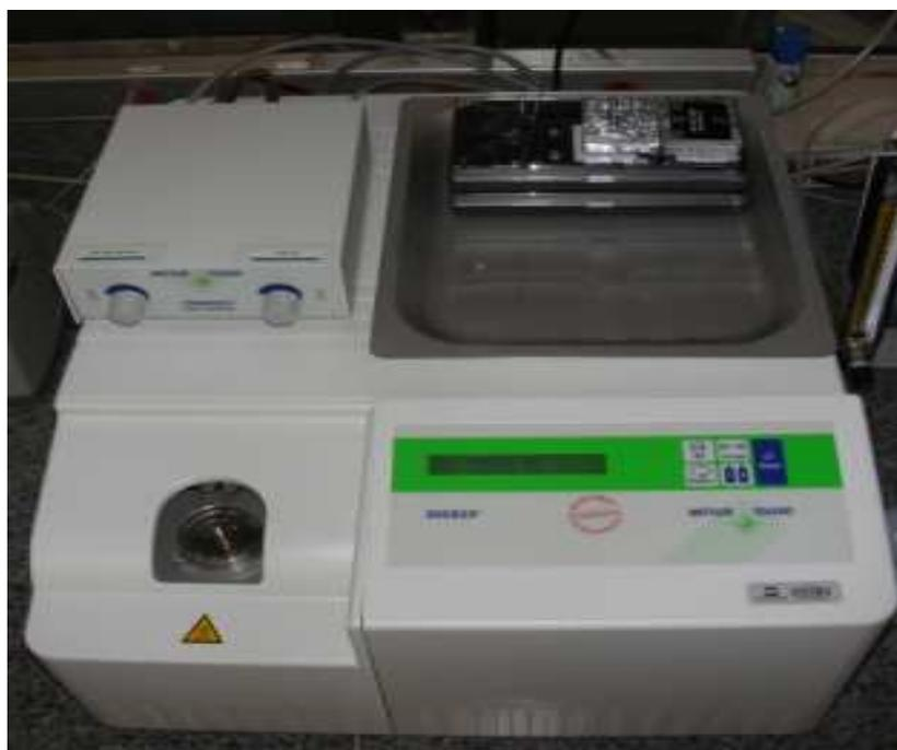
**Figura 3.21** – Analisador DSC, METTLER TOLEDO
