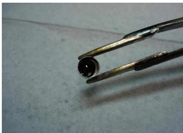
**Figura 3.18** – Suporte de platina com óleo para análise TG/DTA
