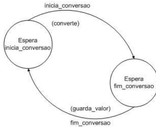
Figura 4.3: Máquina de estados do módulo Conversor A/D
