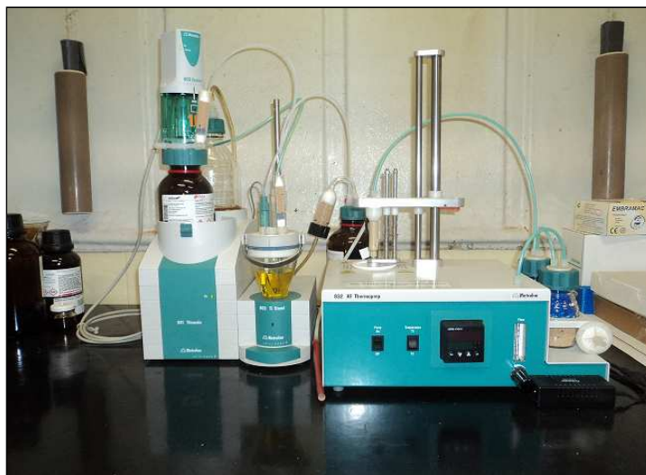
Figura 4.2 - Equipamento Karl Fischer para Medição do Teor de Água no Óleo
