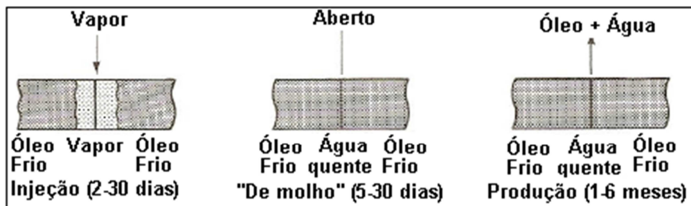
Figura 2.1 - Injeção cíclica de vapor (Green & Willhite, 1998)
