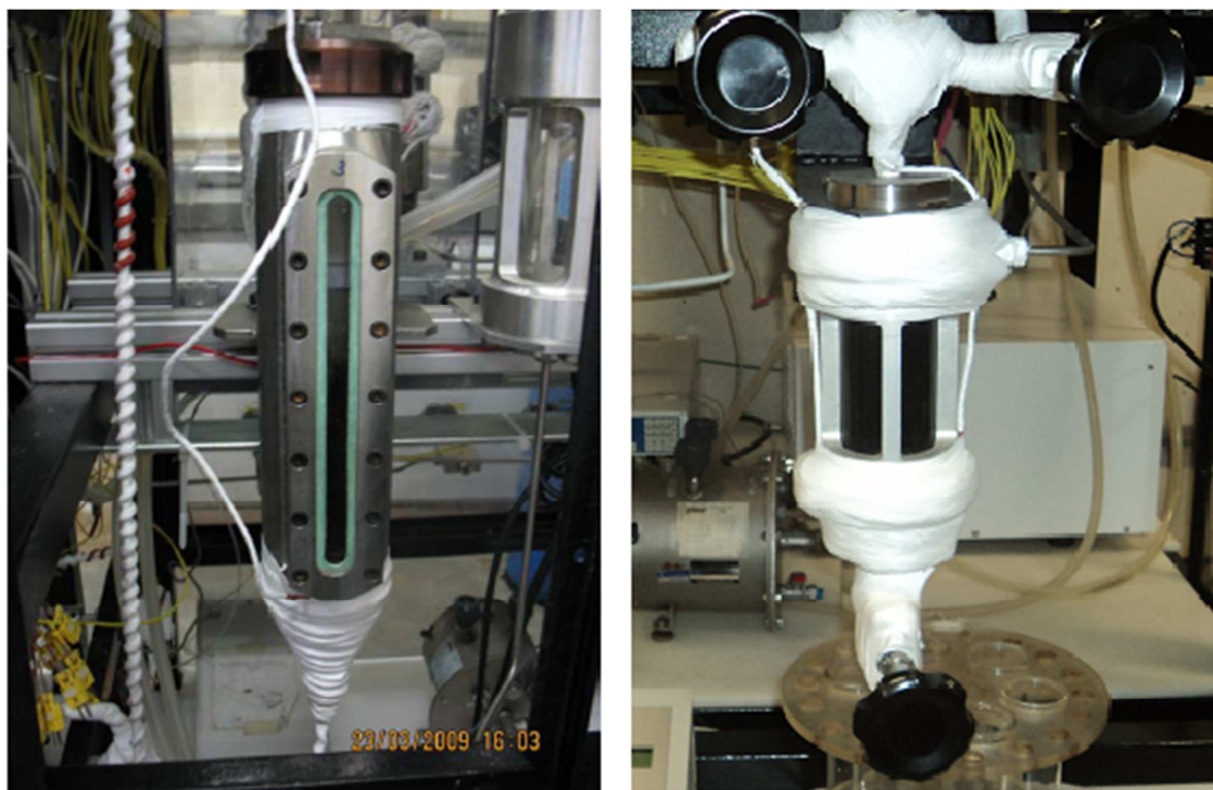
Figura 3.8 -Separador antigo à esquerda (Laboissière, 2009) e novo à direita.
