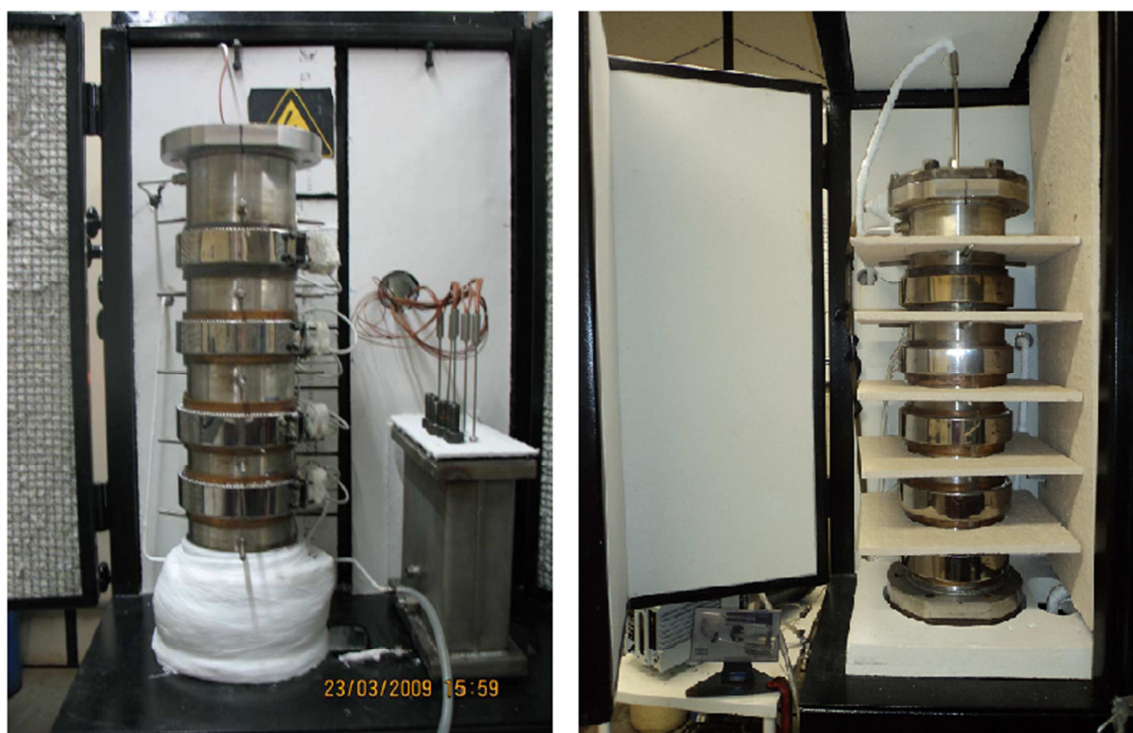
Figura 3.5 - Jaqueta de vácuo antes (Laboissière, 2009) e após as mudanças
