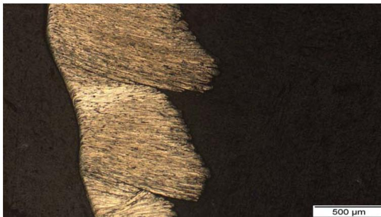
Figura 4.30 – Fotomicrografia óptica do cavaco do aço ABNT 304. Aumento de 50X. Ataque: Eletrolítico com solução de ácido oxálico a 10%.
