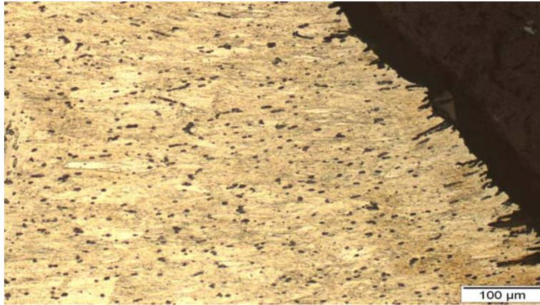
Figura 4.34– Fotomicrografia óptica do cavaco do aço ABNT 304UF. Aumento de 200X.
