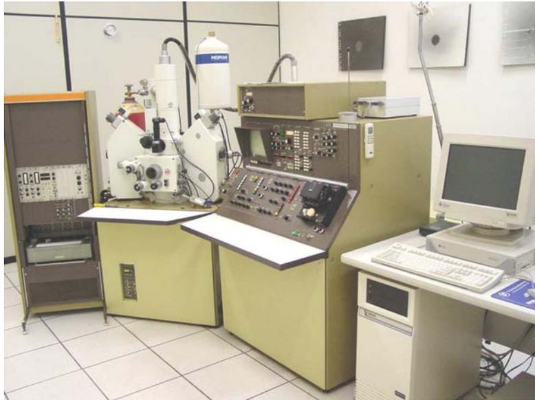
Figura 3.5 – Microscópio eletrônico de varredura da marca JEOL, modelo Superprobe 733. Empresa Villares Metals S/A.
