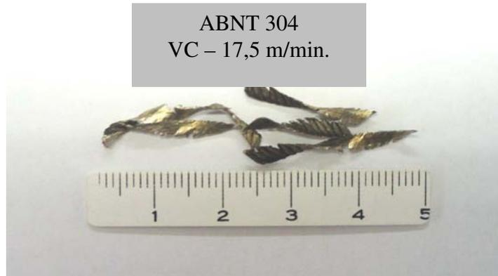
Figura 4.29– Cavaco recolhido na usinagem do aço ABNT 304.
