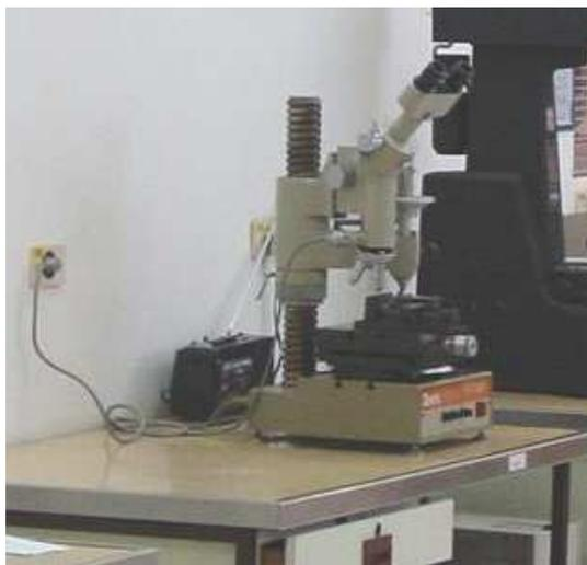
Figura 3.6 – Microdurômetro Vickers da marca ZWICK. Empresa Villares Metals S/A.
