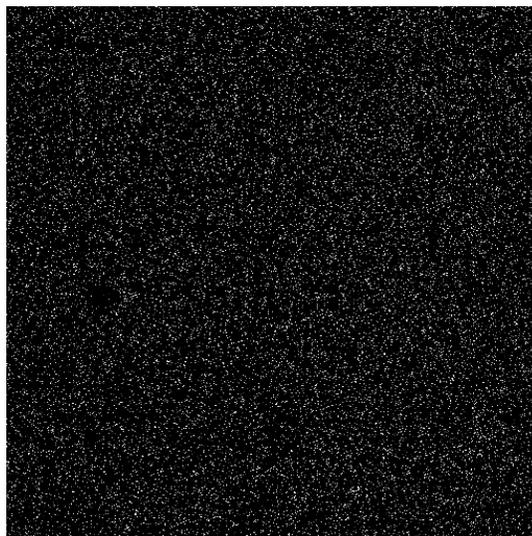
Figura 4.22 – Mapeamento por raios X do silício via WDS do aço ABNT 304. Os pontos brancos na figura revelam a distribuição do silício e a intensidade de pontos brancos é proporcional à quantidade de silício. Aumento: 1.000X.
