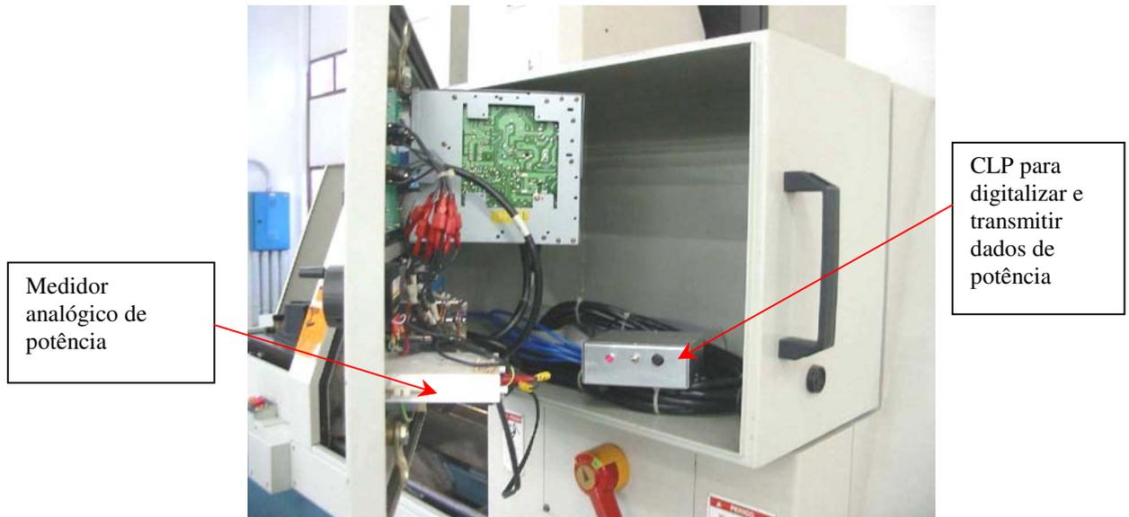
Figura 3.3 - Sistema digital de coleta de potência instalado no CNC.
