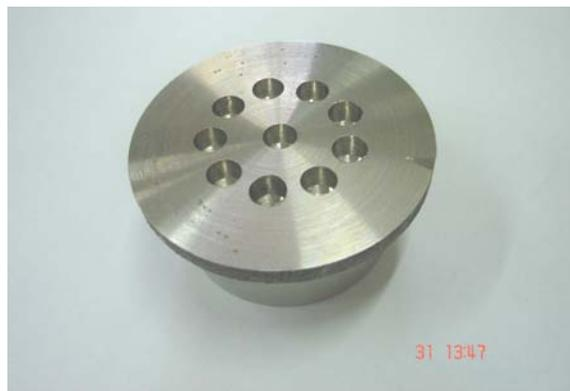
Figura 3.8 - Corpo-de-prova cilíndrico após a furação.
