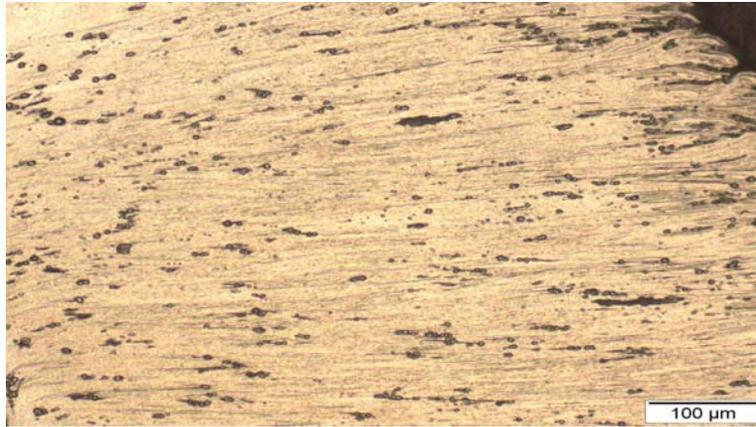
Figura 4.31 – Fotomicrografia óptica do cavaco do aço ABNT 304. Aumento de 200X. Ataque: Eletrolítico com solução de ácido oxálico a 10%.
