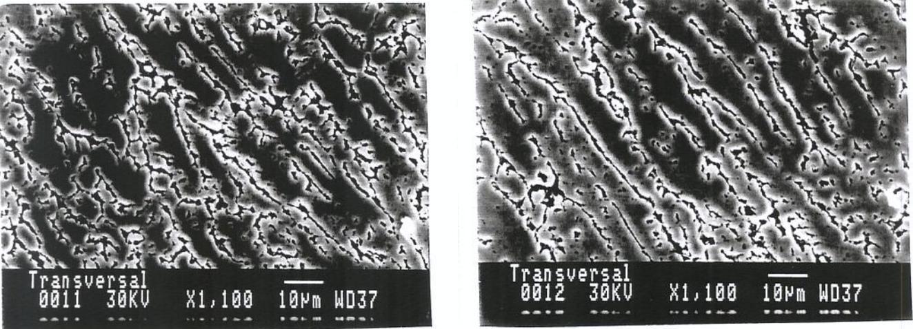
Fig. 10.43 e 10.44 - Micrografia - microscópio eletrônico de varredura crescimento dendrítico - 1100x
