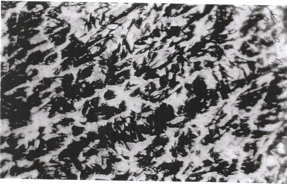
Fig. 10.37 - Micrografia - camada - P20 (2) (0.15 g/s) - 2000 x
