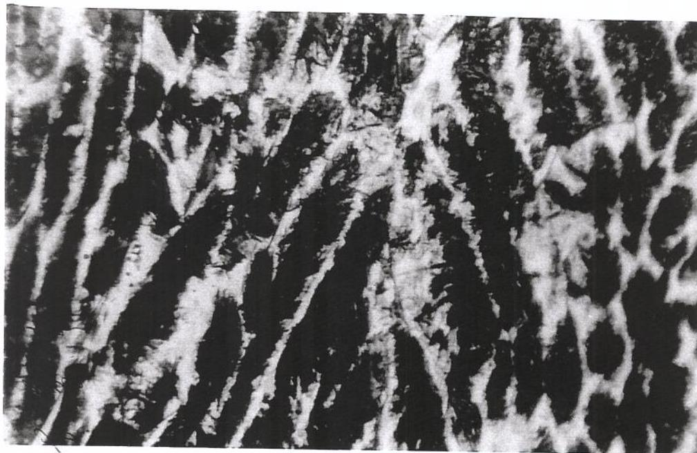
Fig. 10.32 - Micrografia - camada próximo a interface - P20 (2) (0.15 g/s) - 2000 x
