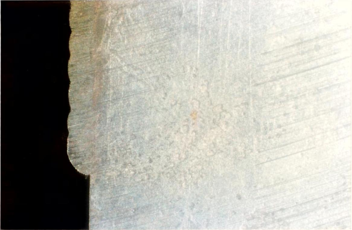
**Fig. 10.61 - Aspecto da interface substrato camada sujeita ao meio corrosivo por 300 horas. - 12.5x**
