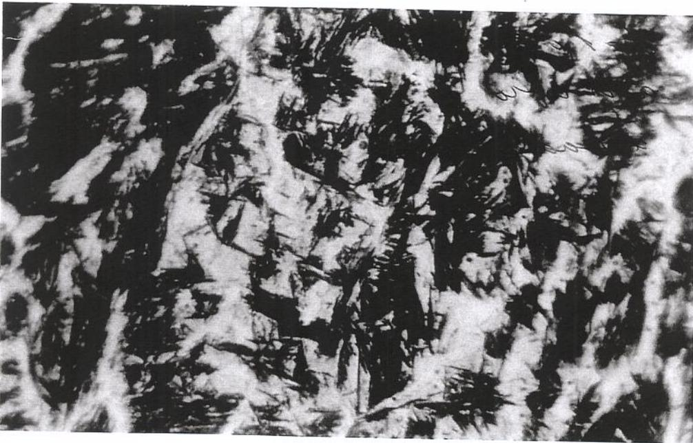
Fig. 10.35 - Micrografia - camada - P20 (2) (0.15 g/s) - 2000 x
