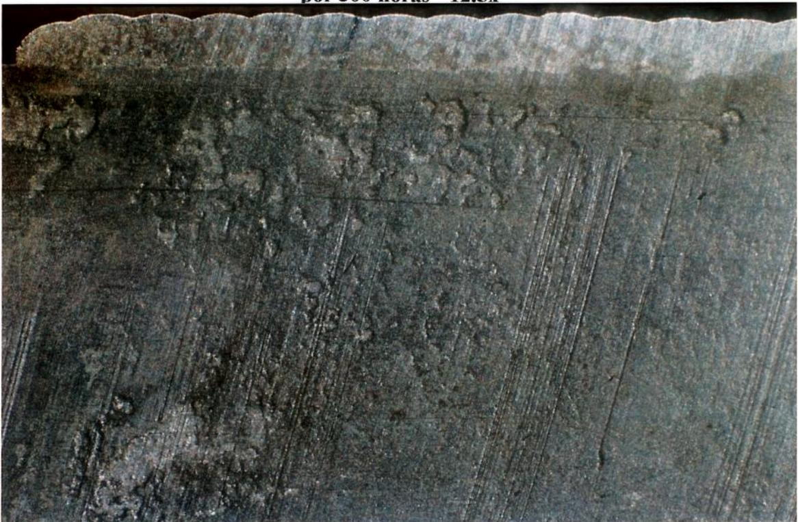
**Fig. 10.60 - Aspecto da interface substrato camada sujeita ao meio corrosivo por 300 horas. - 12.5x**
