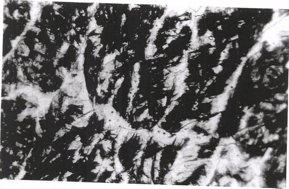
Fig. 10.34 - Micrografia - camada - P20 (2) (0.15 g/s) - 2000 x
