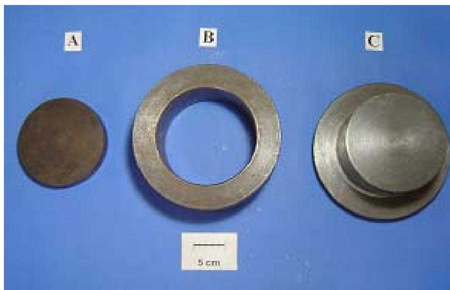
Figura 3.2 - Imagem Fotográfica: Ferramenta de Prensagem, base (A), o corpo (B) o punção (C)
