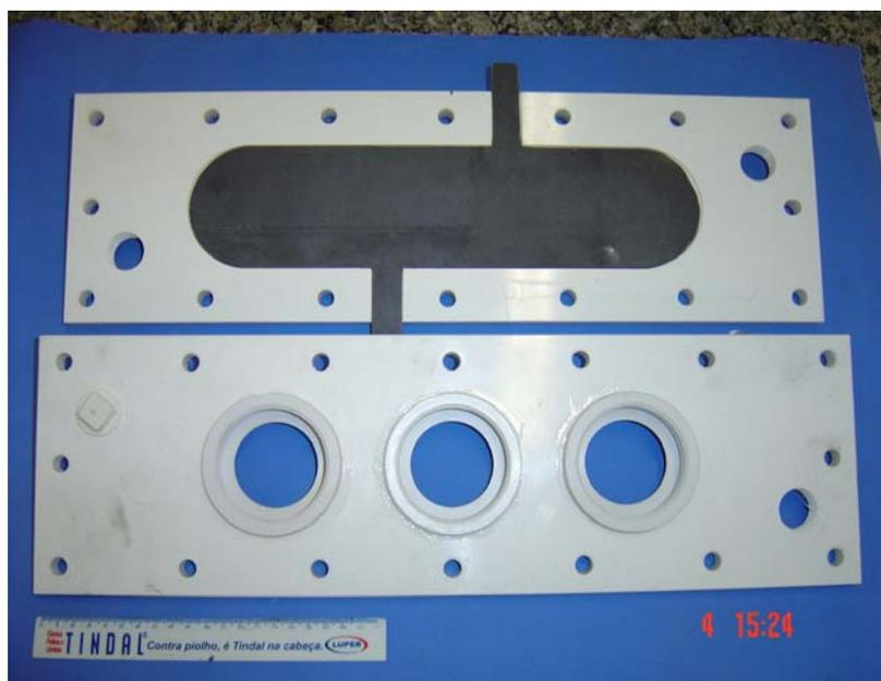
Figura 3.7 – Imagem fotográfica dos componentes do reator em fase de montagem. Placas do catodo (EDG) e do anodo (eletrodo do tipo DSA<sup>®</sup>) em perspectiva
