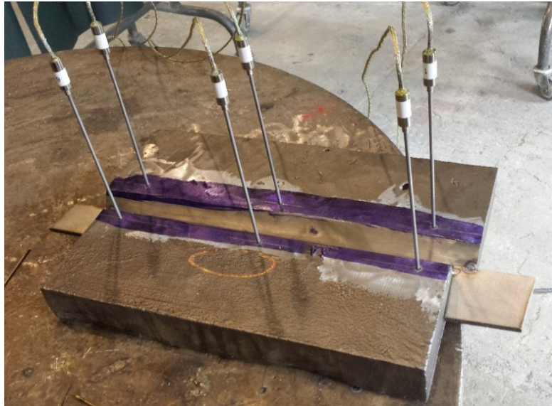
Figura 3.5: Montagem realizada para o monitoramento da temperatura de interpasse.
