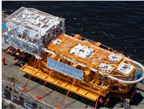
Figura 1.3: Estação de processamento submarino típico (PetroNotícias, 2013).
