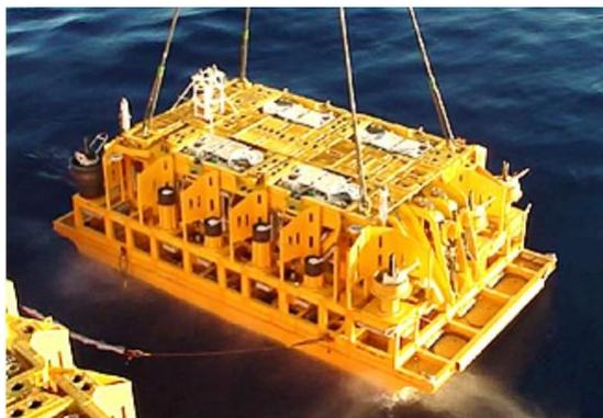
Figura 1.2: Manifold submarino típico (TecPetro, 2014).
