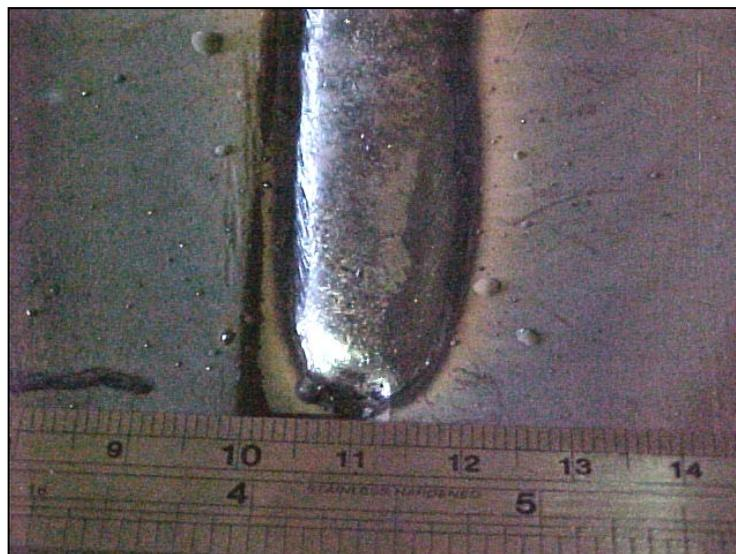
Figura 4.7: Homogeneidade típica para os cordões de solda.
