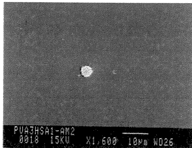
Figura 5.21: Micrografia da Adesão Plaquetária em PE/PVA/HSA
