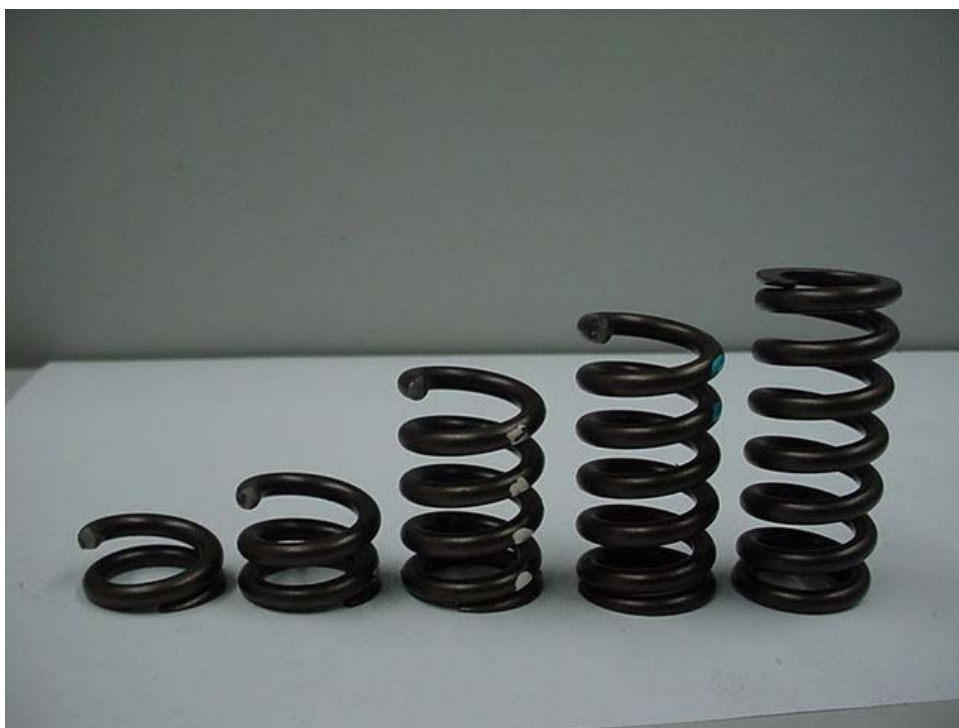
Figura 5.2 - Foto de Mola Helicoidal Nova e Após Fratura em Teste Acelerado
