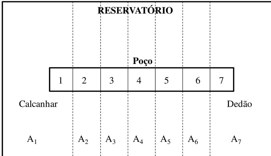
Figura 1.1: Desenho esquemático de um poço horizontal dividido em 7 partes (1 a 7) e respectivas regiões de drenagem ( $A_1$  a  $A_7$ )
