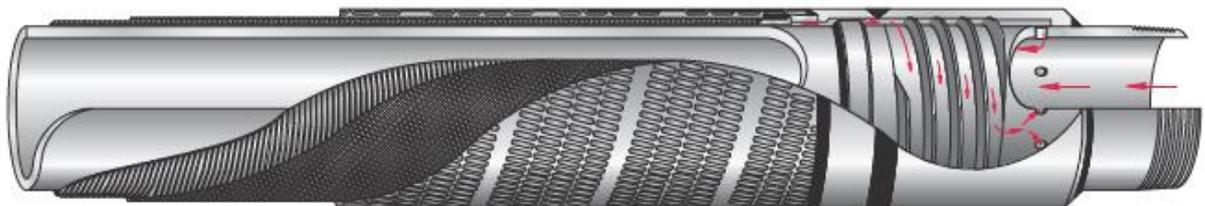
**Figura 2.4: Representação de um Poço com ICD Instalado (Birchenko, 2008)**
