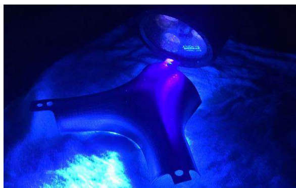
Figura 31 – Análise de descontinuidades com luz ultravioleta em um corpo de prova após o líquido penetrante.
