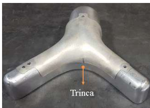
Figura 25 – Peça conformada com 6000 psi (41,37 MPa) que apresentou trinca.
