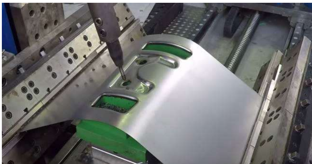
Figura 9 - Integração de estiramento com estampagem incremental e recorte de contorno. (IBF – RWTH Aachen).
