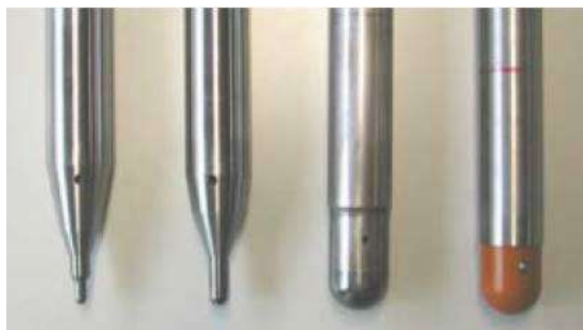
Figura 10 - Exemplo de ferramentas de aço carbono cementadas, com diferentes diâmetros. Da esquerda para direita: 6mm, 10mm, 30mm e uma ferramenta com a ponta de material polimérico. Fonte: HIRT (2004) in JESWIT et al. , (2005).
