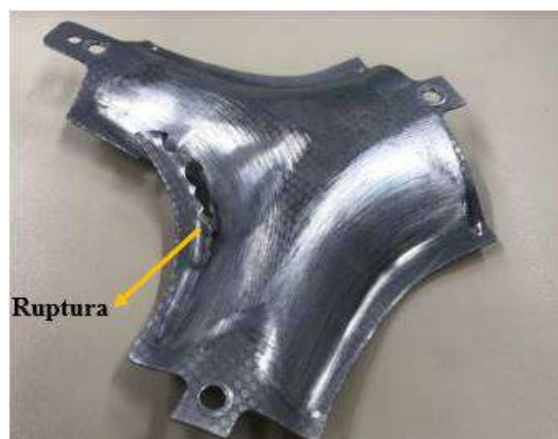
Figura 26 - Corpo de prova em AA7475-T761 que sofreu ruptura durante a estampagem incremental direta.
