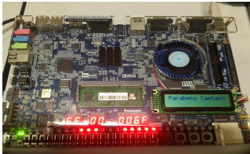
Figura 5.3 – FPGA Altera® Cyclone IV De2i-150 Fonte: Próprio Autor (ALMEIDA, 2015; ALMEIDA *et al.*, 2017)
