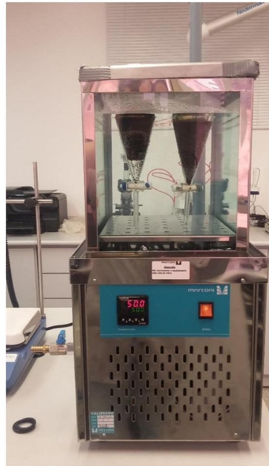
Figura 41: Imagem do experimento de separação após 1 dia do início do teste com as amostras de emulsão 20% A/O (a direita) e com 1000 ppm de aditivo (a esquerda) a 50°C.
