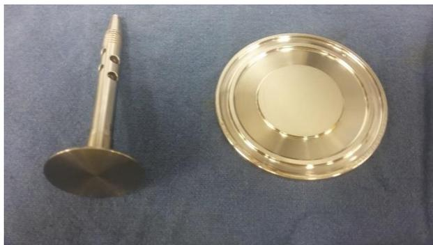
Figura 24: Geometria placa – placa.
