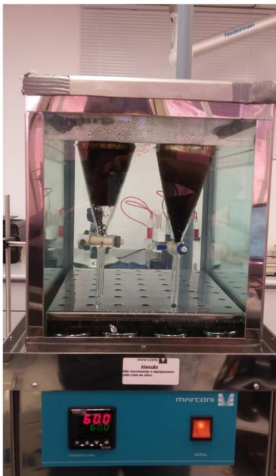
Figura 42: Imagem do experimento de separação após 1 dia do início do teste com as amostras de emulsão 20% A/O (a direita) e com 1000 ppm de aditivo (a esquerda) a 60°C.
