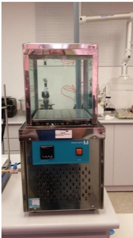
Figura 29: Banho termostatizado para visualização para análise de *Bottle Test*.
