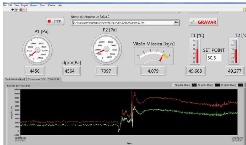
Figura 21: Layout da tela do computador mostrando o supervisorio da aquisição de dados.
