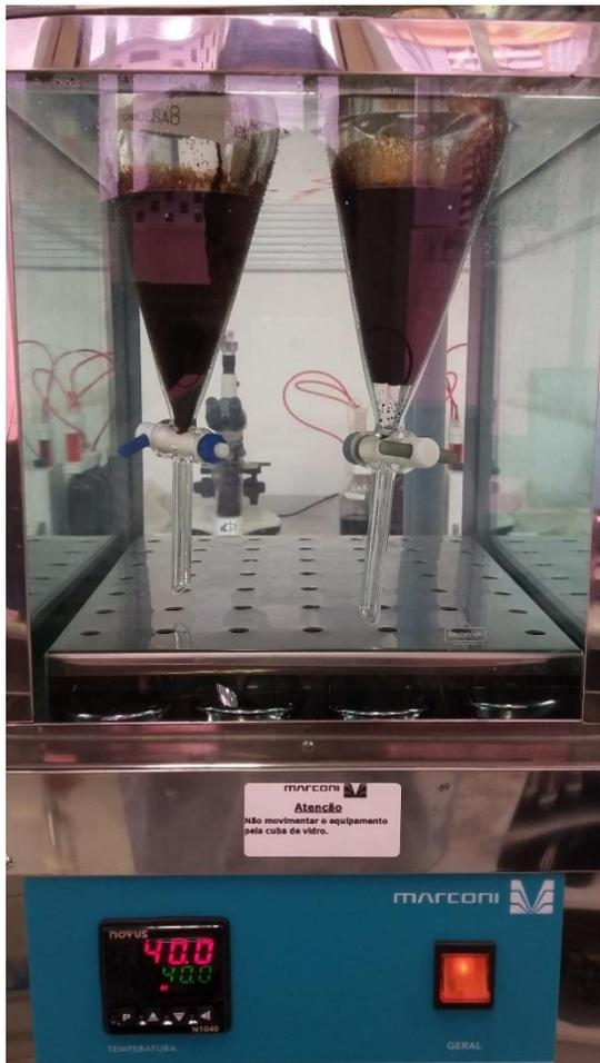
Figura 40: Imagem do experimento de separação após 1 dia do início do teste com as amostras de emulsão 20% A/O (a esquerda) e com 1000 ppm de aditivo (a direita) a 40°C.
