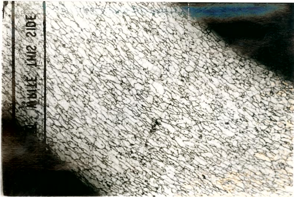
Figura 5.1 - Micrografia da chapa utilizada nos experimentos ( ampliação 100 vezes).
