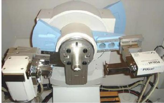
Figura 3.7. Detector de Raios X ultra rápido - PixCel
