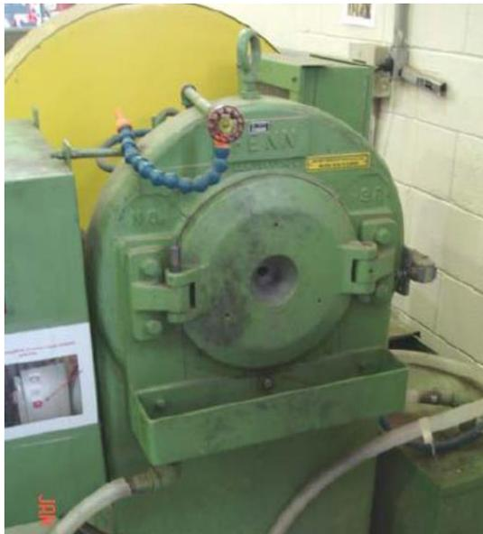
Figura 3.3. Forja rotativa marca FENN, modelo 3F-4 utilizada no forjamento em alta temperatura dos lingotes.
