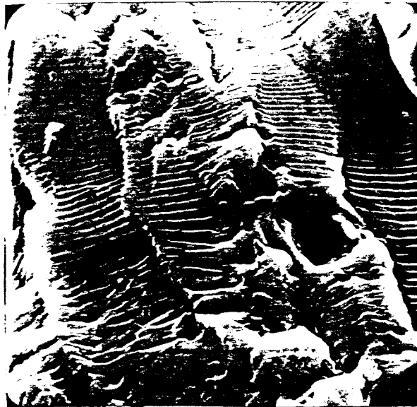
Figura 2.9: Fotografia típica mostrando estrias de fadiga [70] .
