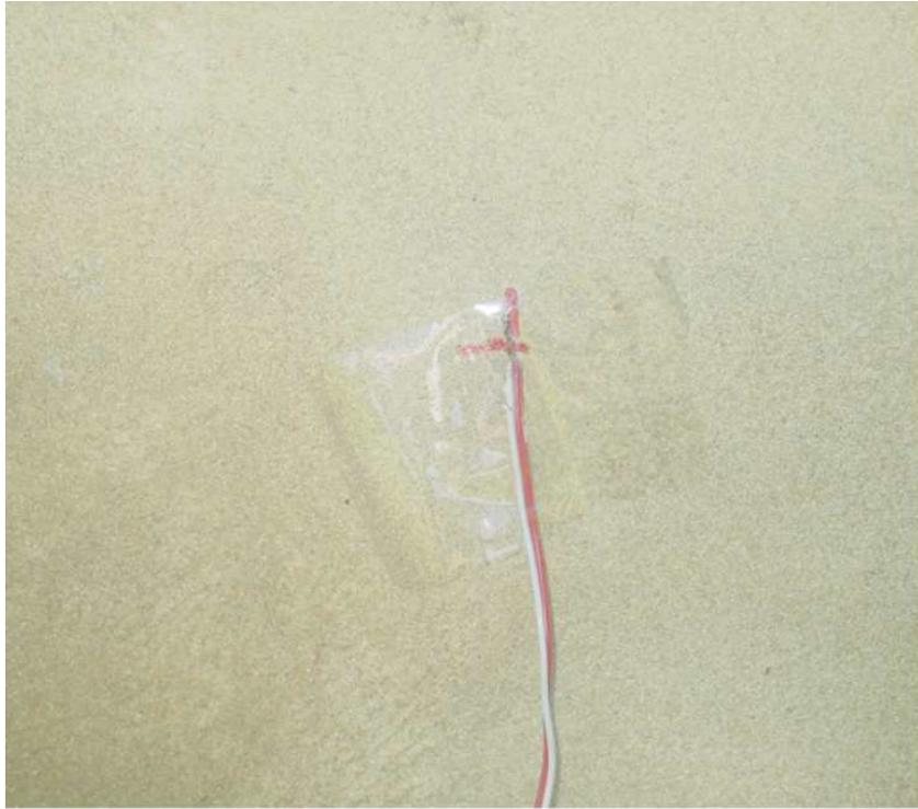
Foto 3: Detalhe da fixação do termopar na alvenaria
