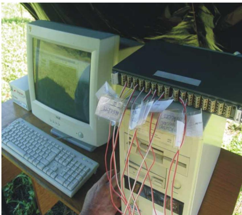
Foto 7: Computador, interface e identificação dos termopares
