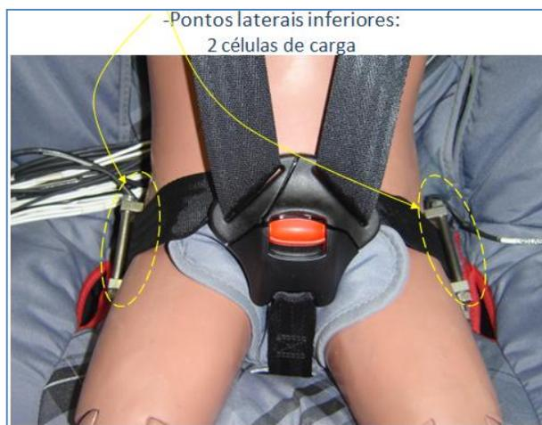
Figura 3. 5 – Células de carga, caderço abdominal pontos laterais inferiores
