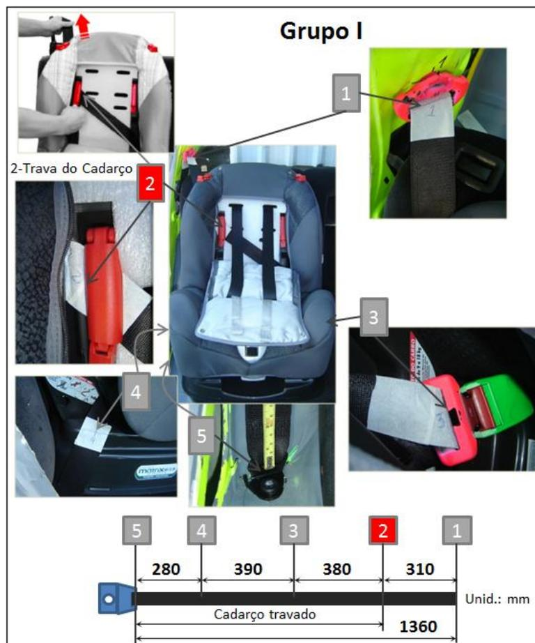
Figura 3. 7 – Medição do comprimento do cadoarço do cinto de segurança usado para instalar o dispositivo de retenção conforme o Grupo de massa I.
