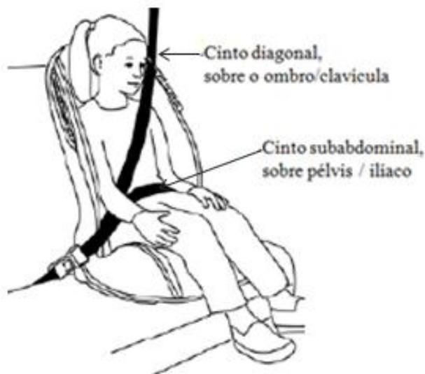
Figura 2. 14 – exemplo de dispositivo de retenção classe não integral (figura adaptada do site “Car seat, harness type” - [http://www.carseat.org/Technical/tech\\_update.htm](http://www.carseat.org/Technical/tech_update.htm) - consulta em Outubro 2011).
