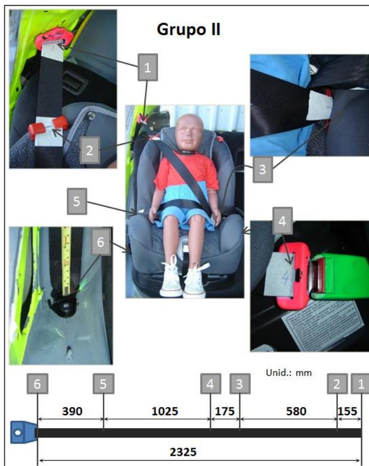
Figura 3. 8 – Medição do comprimento do cadarço do cinto de segurança usado para instalar o dispositivo de retenção conforme o Grupo de massa II.
