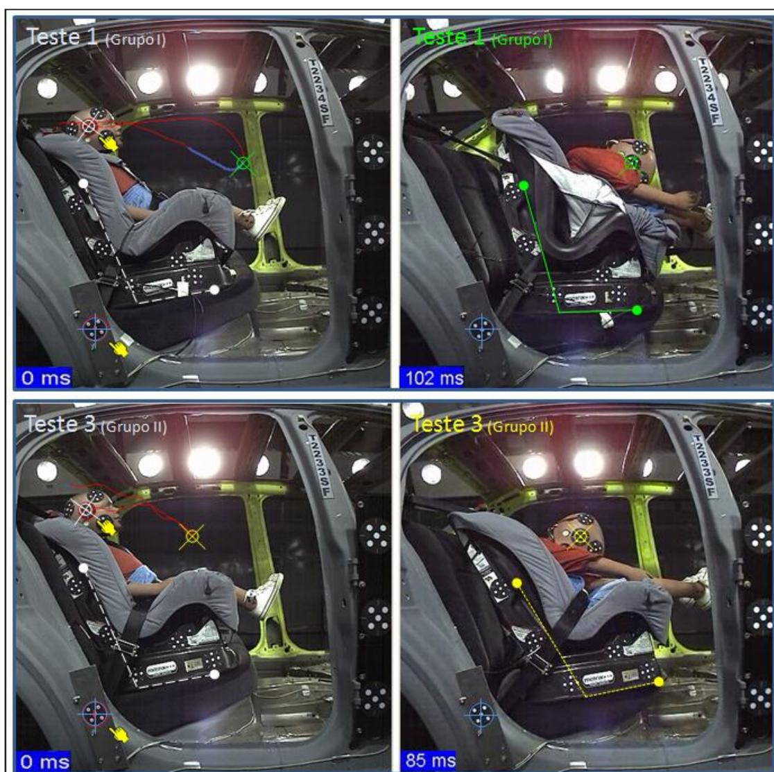
Figura 4. 3 – Comparação da excursão do dispositivo de transporte de criança e manequim entre testes com dispositivo instalado conforme Grupo I e II.
