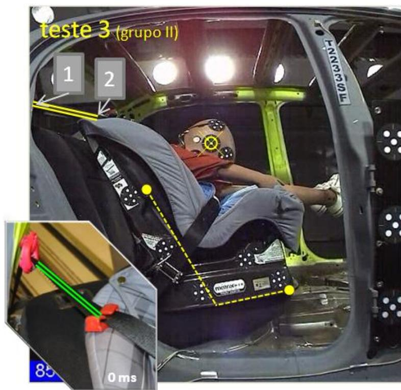
Figura 4. 7 – Deslocamento do dispositivo de retenção instalado conforme grupo II
