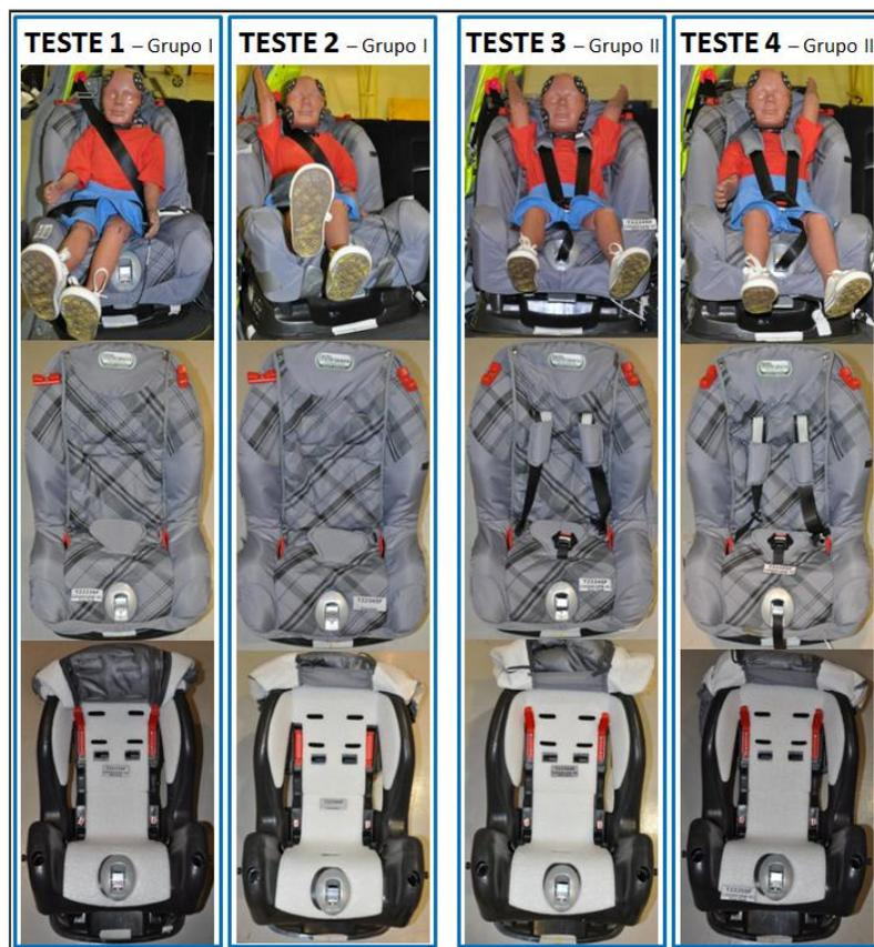
Figura 4. 1 – Condição do manequim e dispositivo de retenção após 1º Bloco de testes
