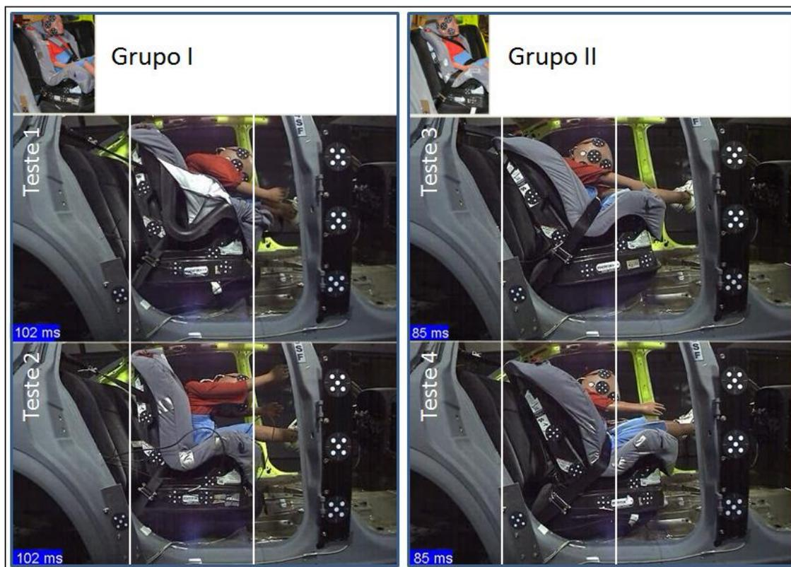
Figura 4. 2 – Comparação da excursão do dispositivo de retenção e manequim.
