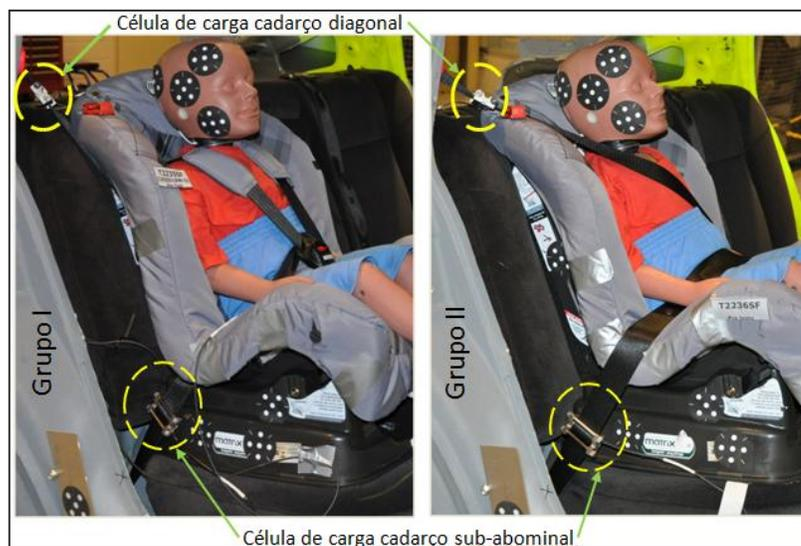
Figura 3. 6 – Posição das células de carga usadas para coletar a carga do cinto de segurança durante os testes dinâmicos.
