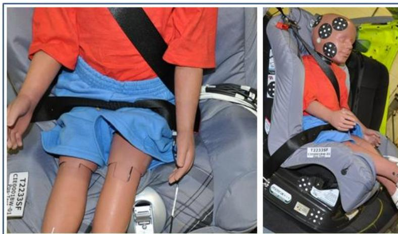
Figura 4. 15 – Análise da penetração abdominal no dispositivo de retenção Grupo II.
