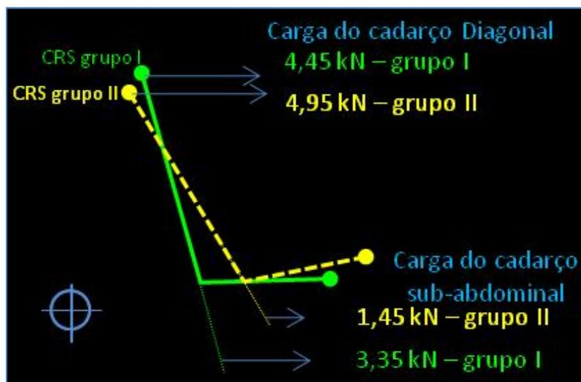
Figura 4. 12 – Carga no cadarço do cinto de segurança e movimentação do dispositivo
