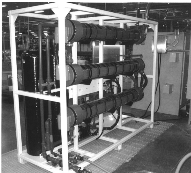
Figura 2. 18. Eletrolisador com múltiplas pilhas de células eletrolíticas
