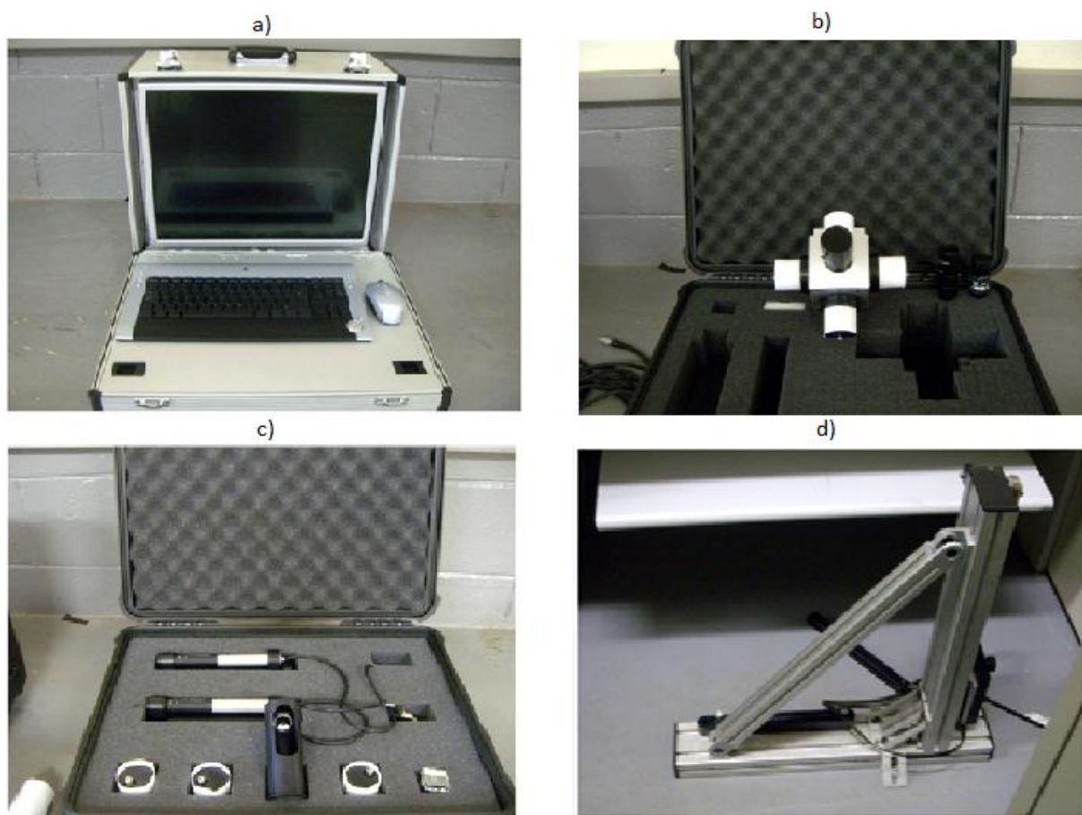
Figura 3.3 – Dispositivo ESPI a) CPU, aquisição de dados e interface; b) Fonte laser; c) Braços extensores; d) Fixador.
