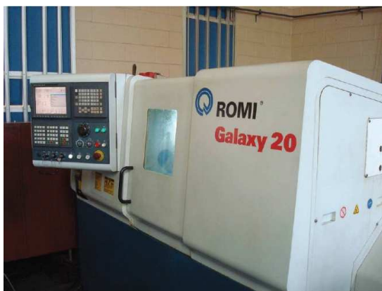
Figura 3.5 Torno CNC Galaxy utilizado nos experimentos (Therezani, 2012).
