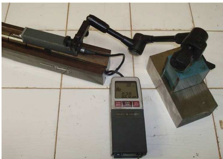
Figura 3.11 Montagem para medição da rugosidade ( Therezani, 2012 ).
