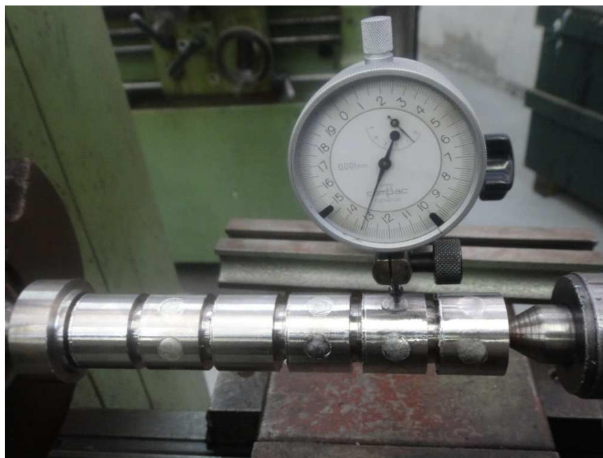
Figura 3.10 Medição da profundidade na superfície da peça.
