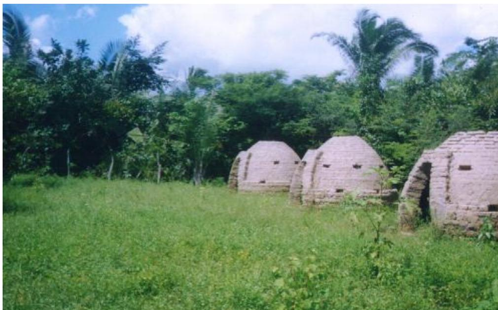
Figura. 2.9: Forno utilizado na fabricação do carvão de coco babaçu. (foto do autor).
