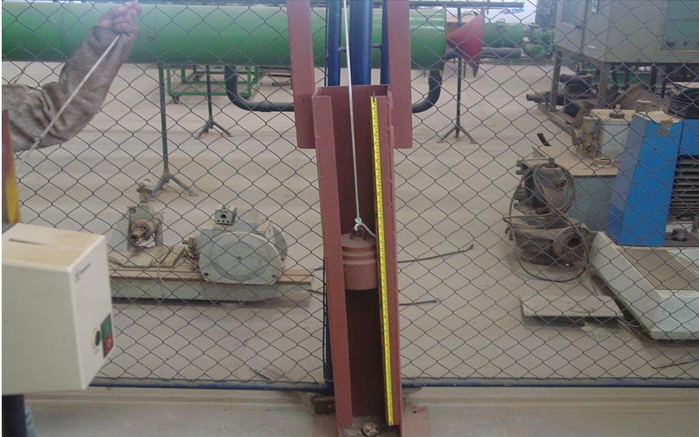
Figura 3.3: Dispositivo utilizado para medir a força de impacto
