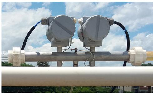
(a) sonda de haste em uma estação de medição;
