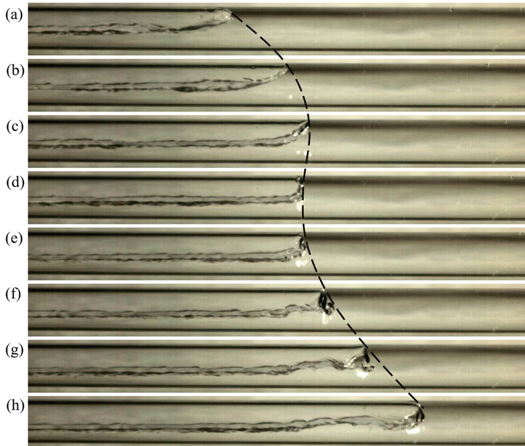
Figura 4.4: Deslocamento retrógrado do nariz da bolha alongada - *Setup B* e  $\sigma = 0,123$ , intervalo de 10 frames ou 0,05 segundos entre fotos. Ponto de filmagem: 131 D à montante da placa de orifício.
