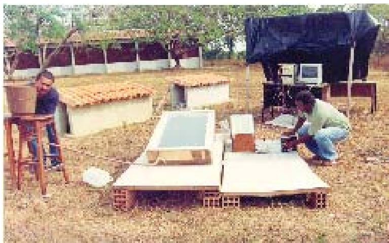
**FIGURA 5.9 – Ensaio do dessalinizador solar híbrido**
