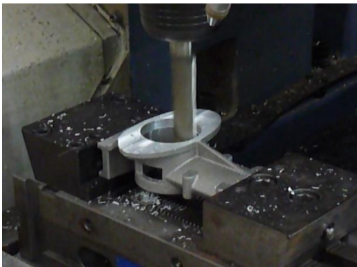
(a) Usinagem da peça
