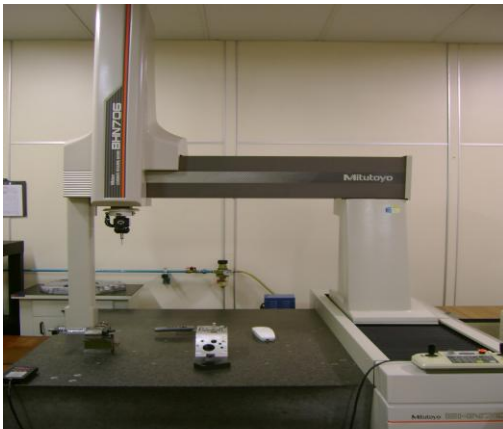
(a) Digitalização ponto a ponto Máquina de medir coordenadas – CMM
