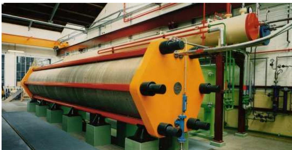
Figura 3.3 – Eletrolisador bipolar alcalino da empresa ELT. Fonte: ELT, 2011
