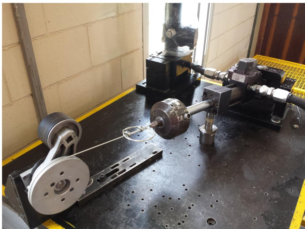
Figura 6.13: Bancada de ensaios para identificação da rigidez torcional do auto-tensionador.
