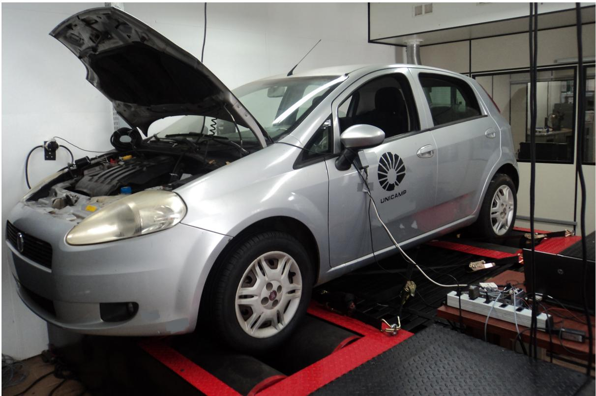
Figura 3.9: Veículo acoplado ao dinamômetro
